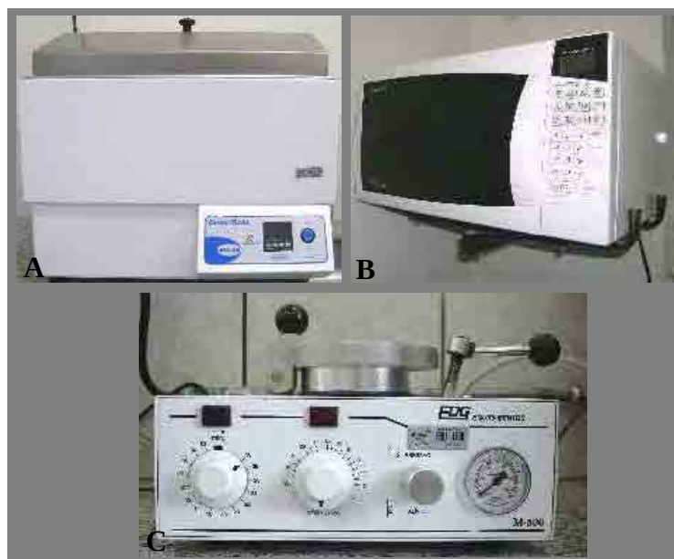
FIGURA 16. Equipamentos utilizados para a polimerização dos espécimes. A) Termopolimerizadora automática Solab; B) Forno de microondas Panasonic; C) Multipolimerizadora modelo M 500.
