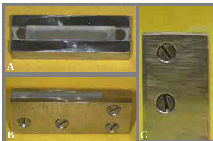
FIGURA 10. Matrizes para desgaste dos espécimes: A) Matriz para desgaste em espessura; B) Matriz para desgaste em largura; C) Matriz para desgaste em comprimento.
