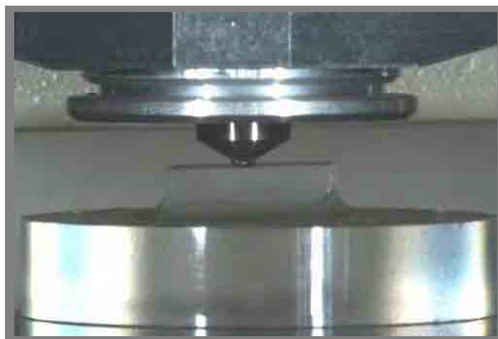
FIGURA 23. Penetração do diamante sobre a superfície do espécime.
