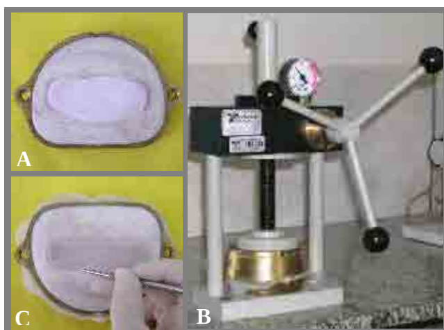
FIGURA 14. Prensagem da resina termopolimerizável: A) Massa da resina na fase plástica acomodada no interior do molde de silicone; B) Mufla metálica sob prensa hidráulica; C) Recorte dos excessos após a prensagem inicial.
