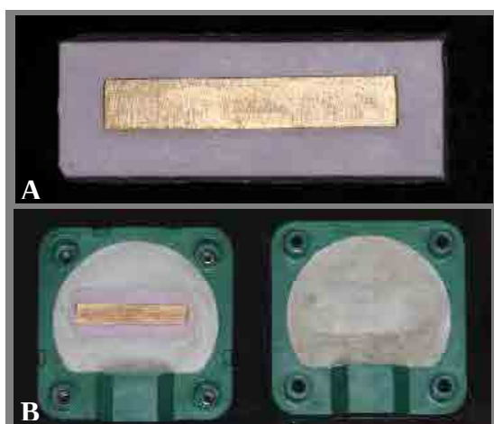
FIGURA 2. Inclusão em mufla: A) Conjunto padrão metálico / silicone; B) Conjunto incluído em mufla plástica com gesso pedra.
