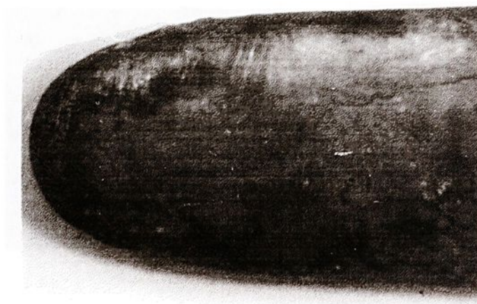
Figura 4.2 - Macrografia da extremidade final, 96 - 100%, dos lingotes de chumbo refinados por SRZ. Aumento de 6 X. Solução de ataque HCl.
