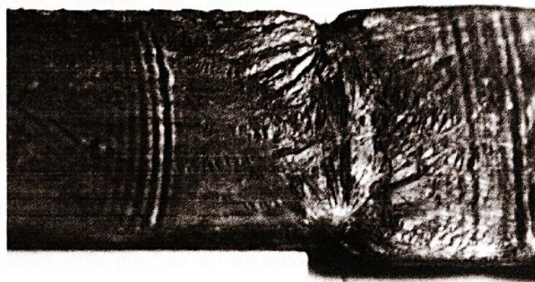
Figura 4.4 - Macrografia de uma lingote fundido por fusão zonal interrompido na quarta passada. Aumento de 12X. Solução de ataque HCl.
