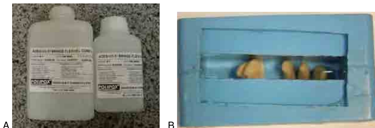
FIGURA 5.2.1 A) Resina fotoelástica CMR 202 e catalisador CMF 252. B) Molde com dentes posicionados após a colocação da mistura de resina e catalisador.
