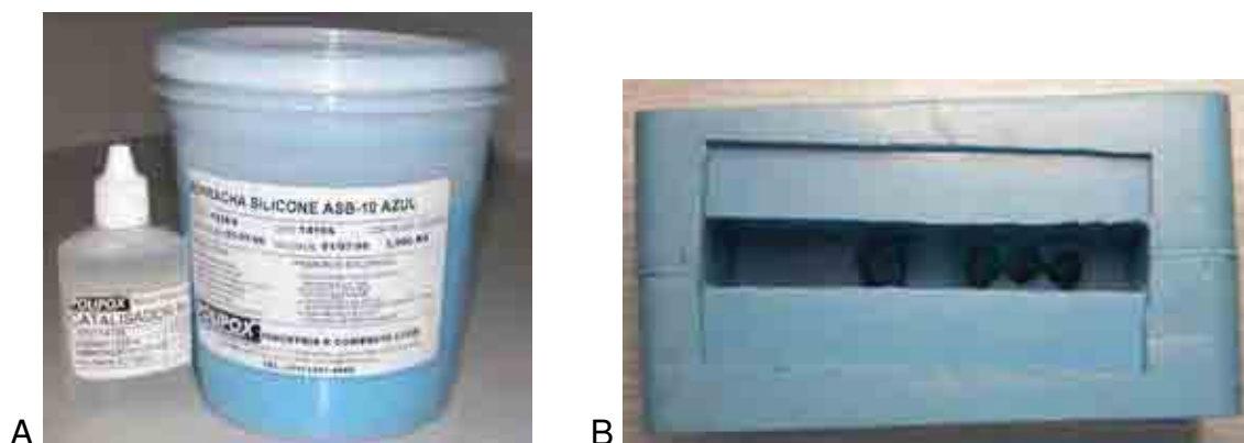
FIGURA 5.1.8 A) Borracha de silicone para moldagem. B) Molde do bloco de cera com os dentes em borracha de silicone.
