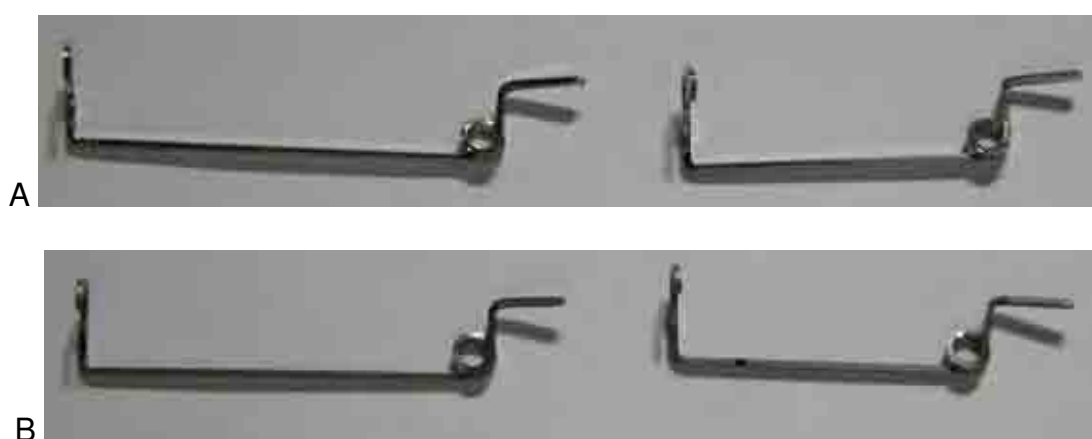
FIGURA 5.3.2 Molas de verticalização nos comprimentos de 25mm e 20mm: A) Em aço inoxidável e B) Em TMA.
