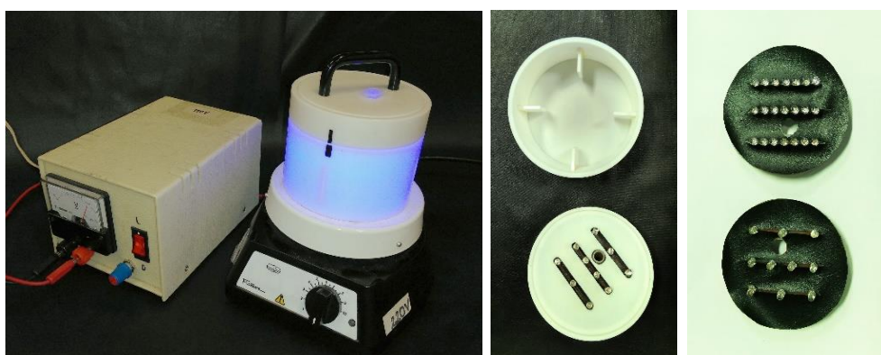
Figura 7- Sistema de reator-dispositivos LED e fonte de alimentação. Fonte: Rojas-Mantilla et al. (2019).
