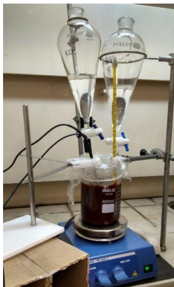
Figura 6- Registro fotográfico realizado durante a síntese dos materiais pelo método de coprecipitação.
