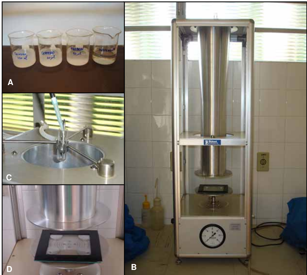
Figura 1. A) Soluções dos produtos; B) Torre de Potter ® utilizada no experimento; C) Soluções dos produtos sendo pipetadas na torre de Potter ® para posterior aplicação; D) Placa de vidro protegida por estrutura plástica sendo pulverizada com inseticida.
