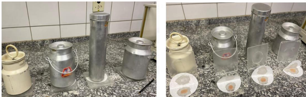
Figura 11 – Análise de CRA com 2 gramas de amostra do Longissimus thoracis submetidas a um peso de 10 kg
