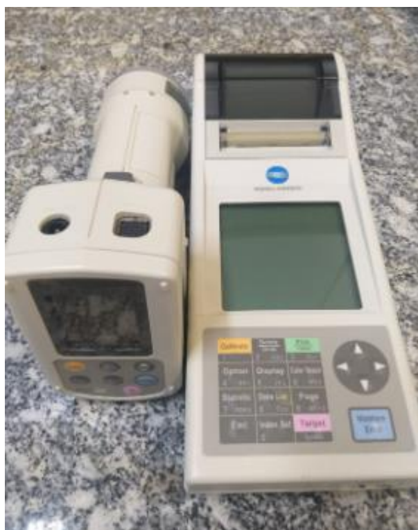
Figura 9 - Colorímetro Minolta Chrome Meter modelo CR-400
