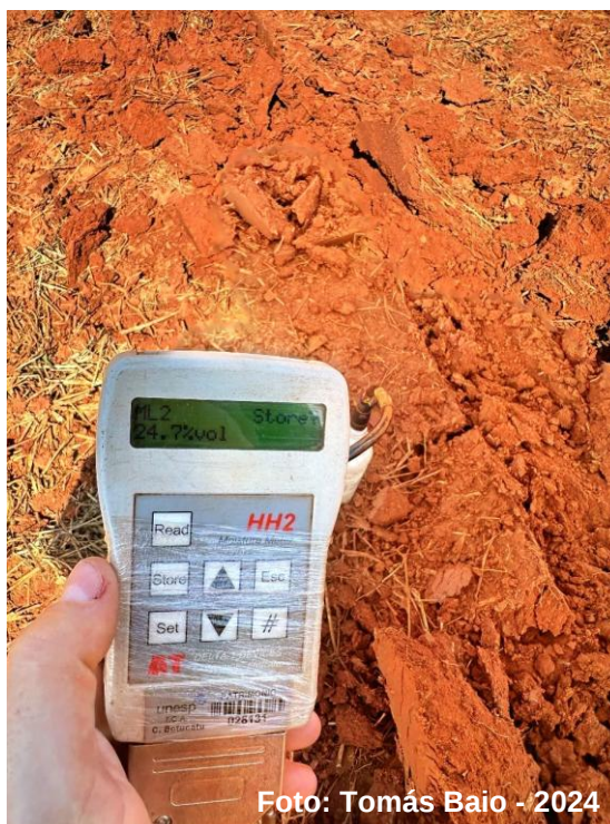
Figura 14 - Equipamento para análise da umidade do solo
