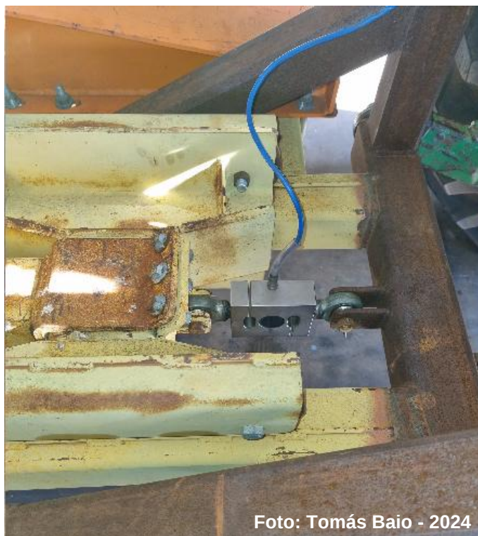
Figura 5 - Estrutura equipada com célula de carga
