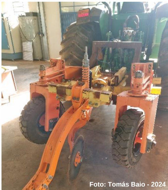
Figura 4 - Estrutura equipada no braço hidráulico do trator
