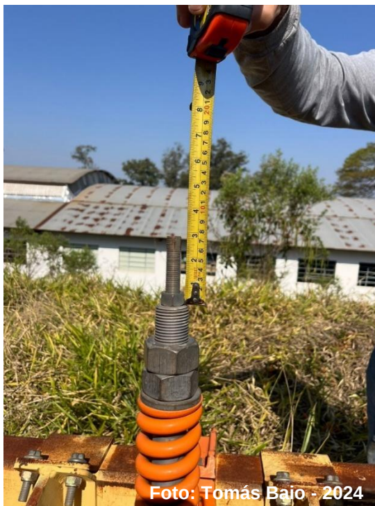
Figura 7 - Avaliação da profundidade de trabalho da haste sulcadora
