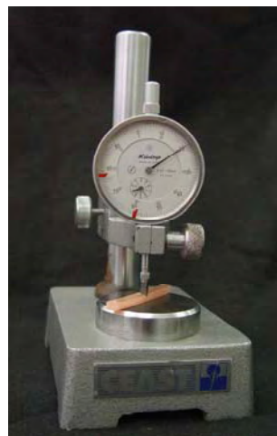
Figura 15 – corpo-de-prova posicionado no medidor de profundidade CEAST
