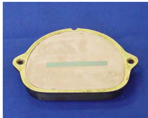
Figura 6 – Padrão de silicone incluído em mufla
