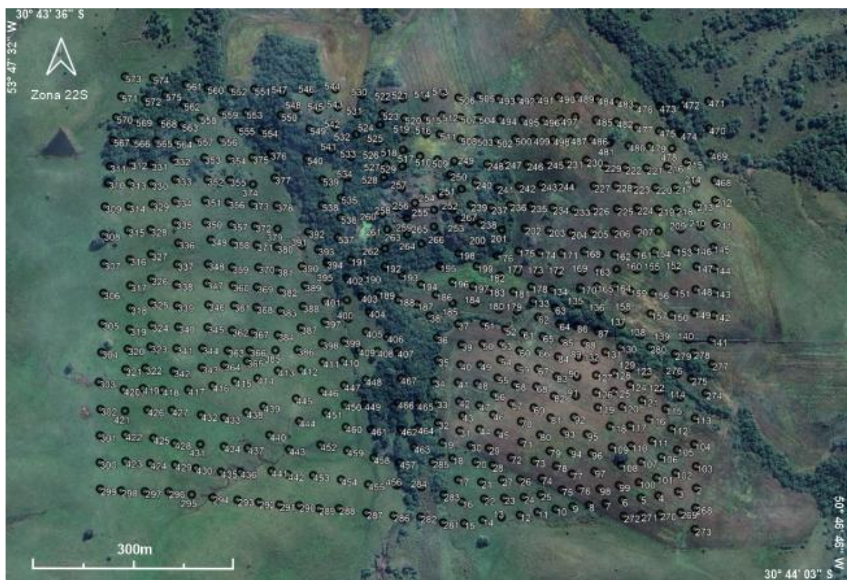
Figura 12 Malha regular para a aquisição dos dados de magnetometria e gamaespectrometria
