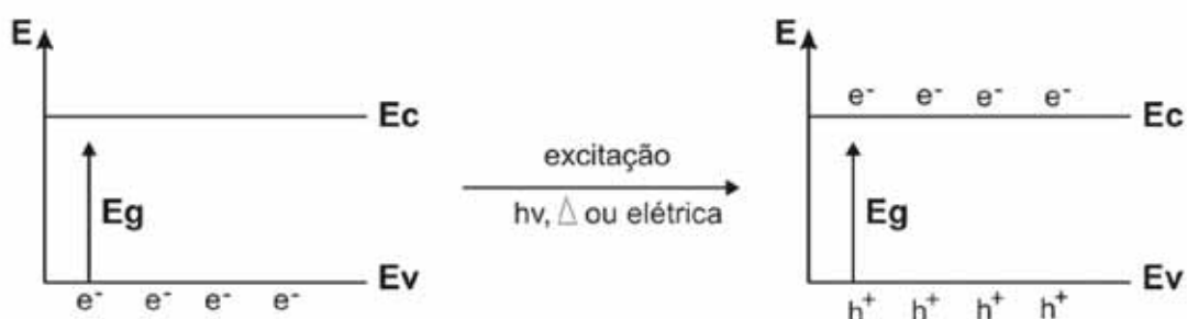
Figura 3: Formação de transportadores de carga por excitação óptica, térmica ou elétrica em semicondutores intrínsecos.
