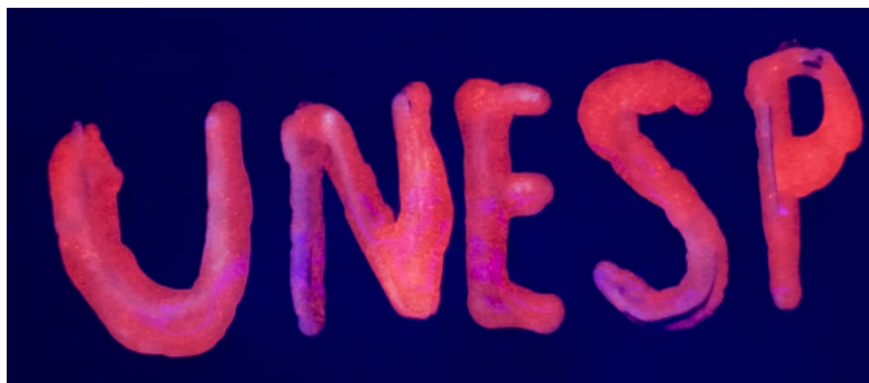
Figura 8: Tinta cintiladora sob a luz ultravioleta no comprimento de onda igual a 375 nanômetros.
