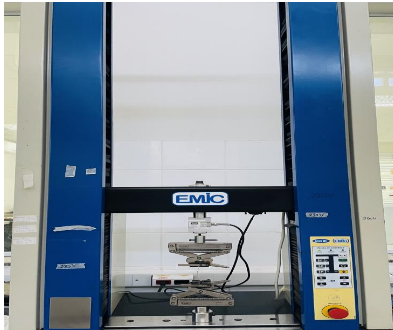
Figura 12 – Máquina universal de ensaio EMIC – Modelo DL-2000
