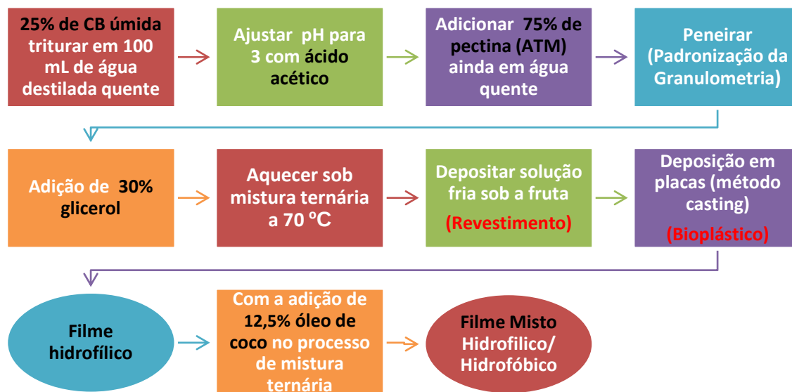
Figura 11 – Fluxograma da produção do revestimento bioplástico
