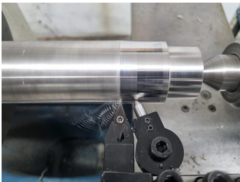
Figura 4: Usinagem e roleteamento do material inconel 718.
