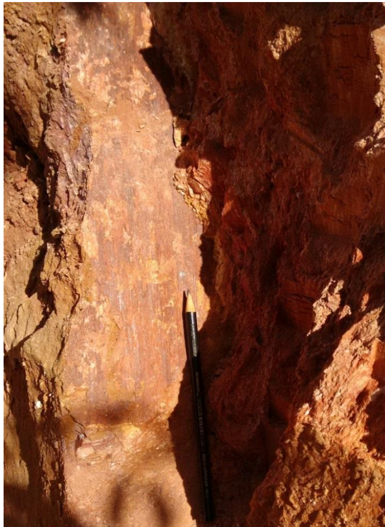
Figura 50: Plano de falha normal (atitude 314/55) em xisto do Complexo Embu. A direção do lápis é paralela à direção das estrias (Afloramento 58).
