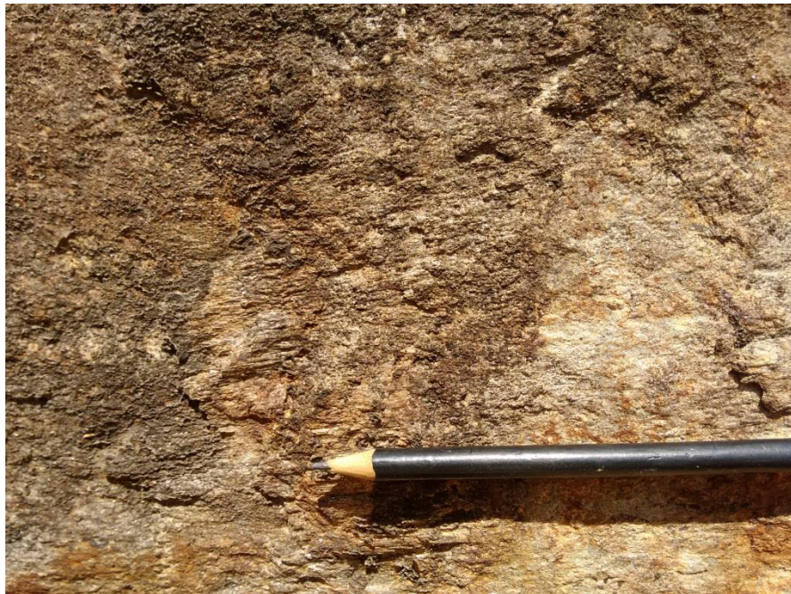
Figura 48: Plano de falha com atitude 208/75 em rocha granítica. As estrias paralelas à direção do lápis e os ressaltos indicam movimento transcorrente destal (afloramento 67).
