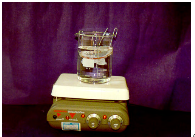
Figuras 13: Sistema para avaliar a solubilidade do filme em água (a - redinha utilizada para apoiar o filme durante a agitação, b - redinha + filme mergulhados em água desmineralizada, c - esquema geral)
