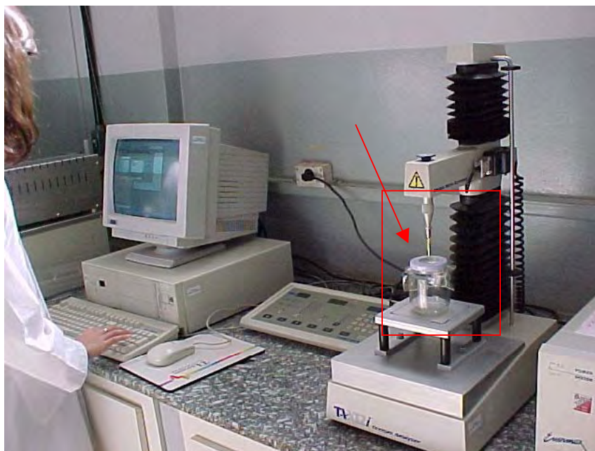
Figura 11: Sistema de medida de força e deformação com destaque (seta) para célula de vidro com abertura circular na tampa para o teste de perfuração
