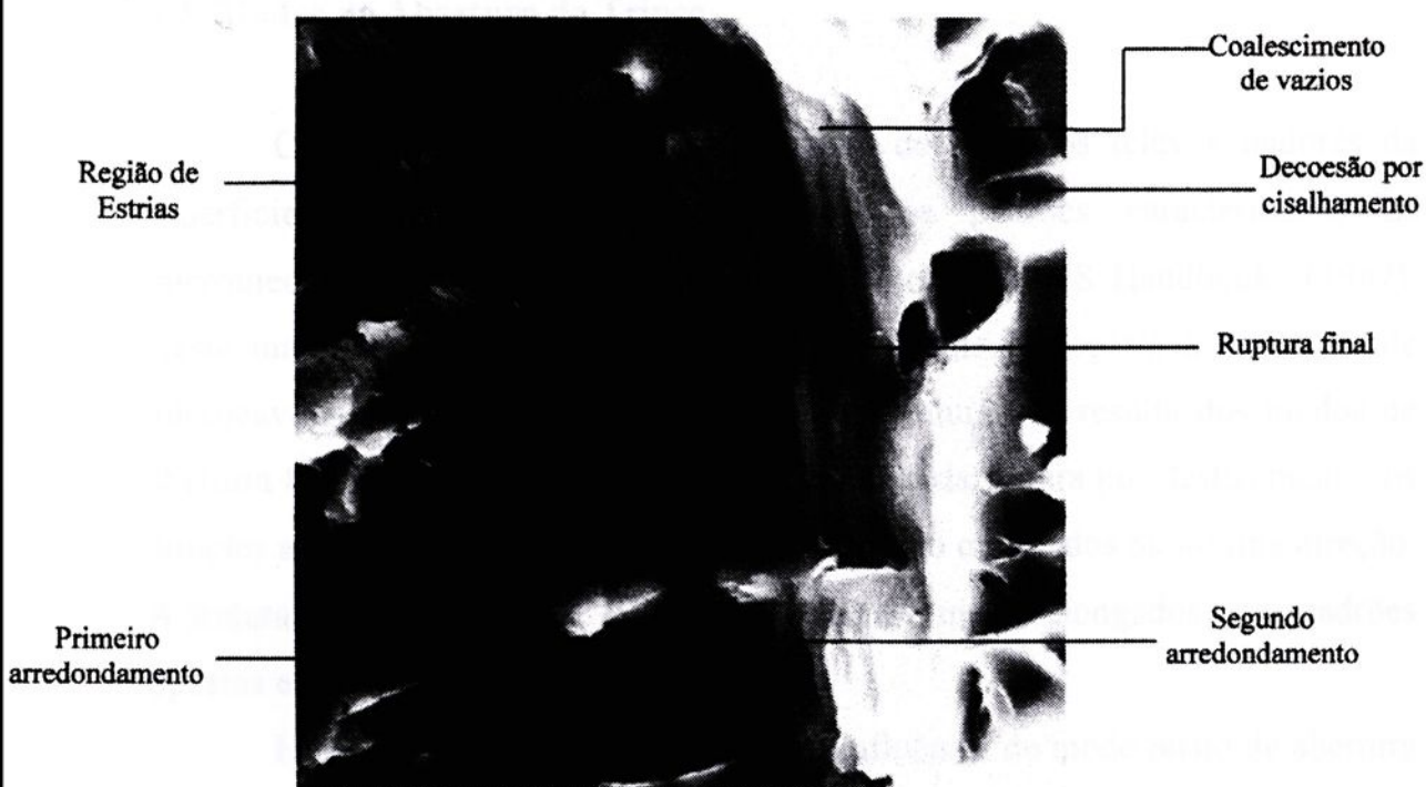
FIGURA 3.2 Identificação das regiões do relevo da zona de estiramento de acordo com El-Soudani (1985)
