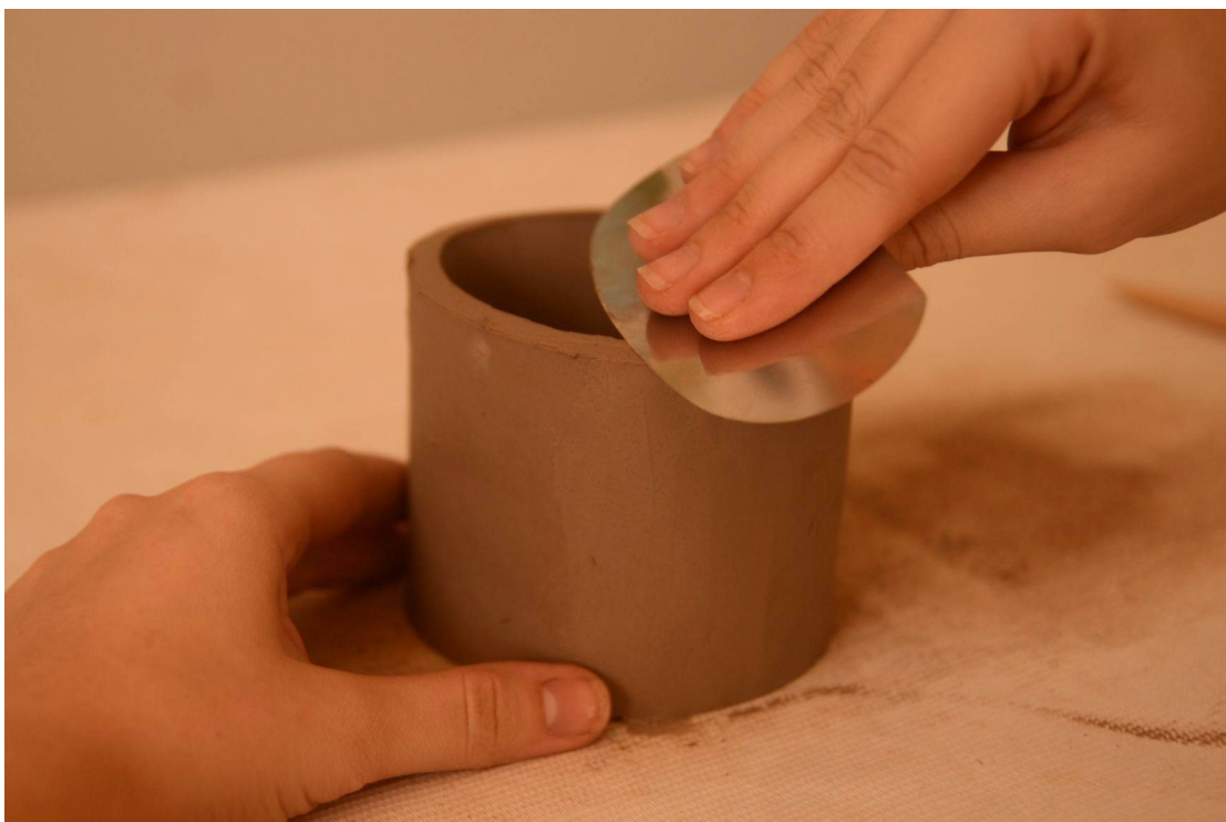
Figura 39: Acabamento com espátula de metal, aperfeiçoando a superfície da peça.
