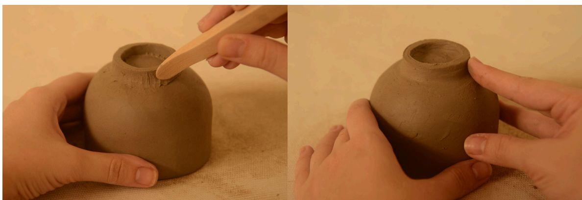
Figura 52: Acabamento da colagem com espátula de madeira e dedos.
