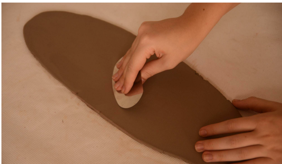
Figura 29: Etapa de alisar a argila e eliminar possíveis bolhas presentes na placa.
