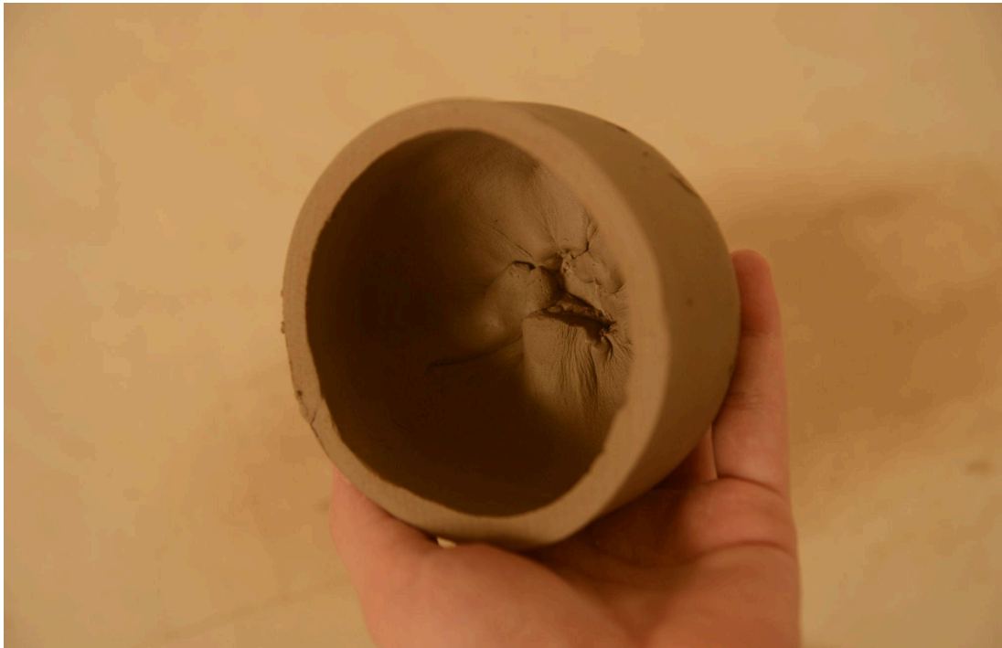
Figura 45: Dobras originadas pelo processo de arredondamento da base.
