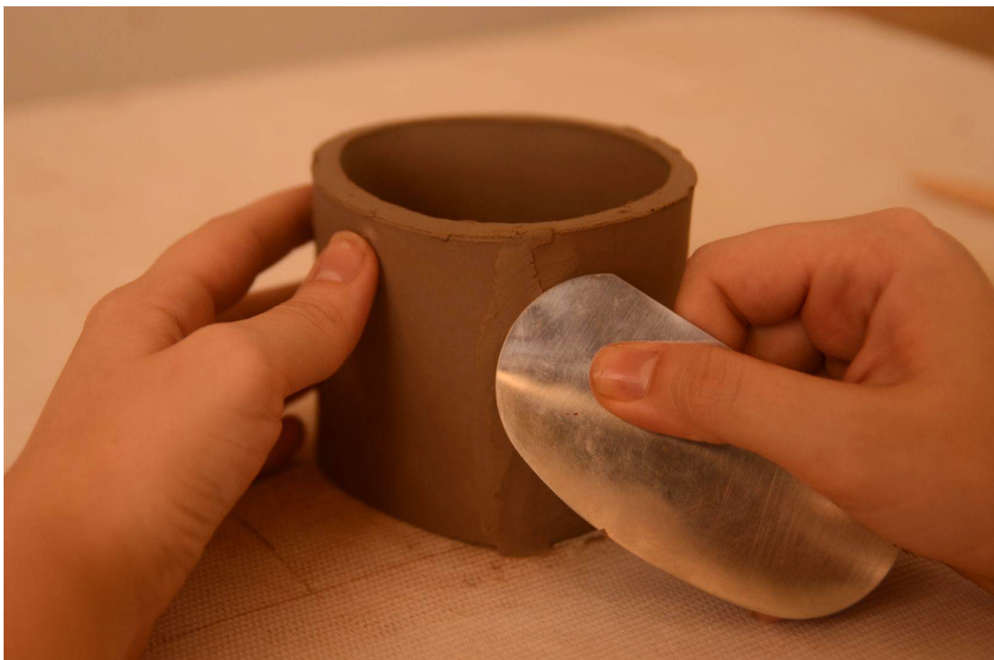
Figura 38: Acabamento com espátula de metal, aperfeiçoando a superfície da peça.
