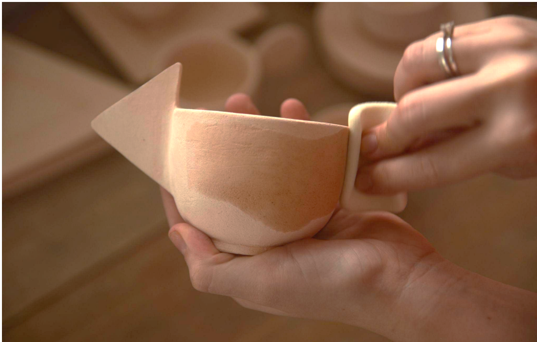
Figura 62: Limpeza da peça de biscoito para esmaltação.
