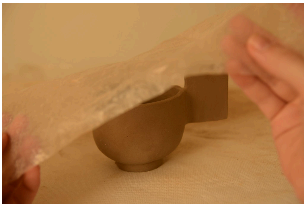
Figura 58: Etapa de secagem protegida com plástico para retardar a perda de umidade.
