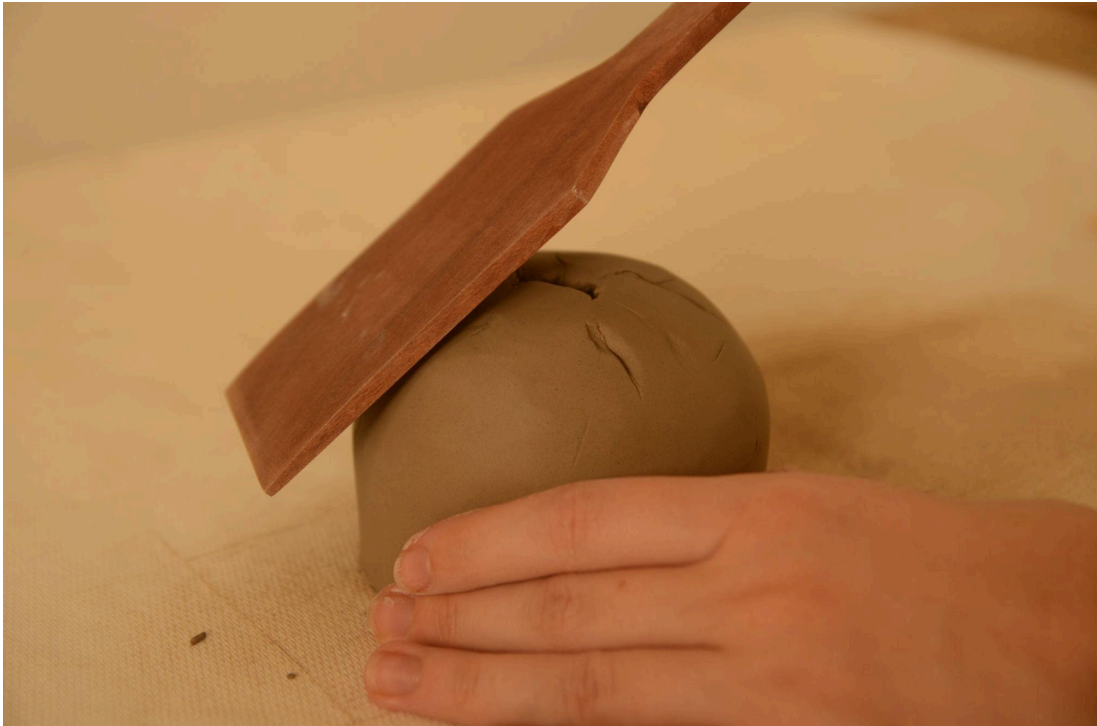
Figura 41: Técnica de batidas, com espátula chata de madeira, para compactar a argila da curvatura.
