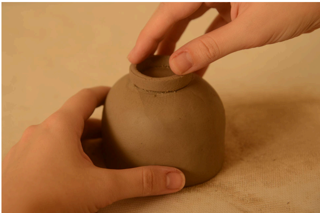
Figura 50: Inserção do pé da xícara.
