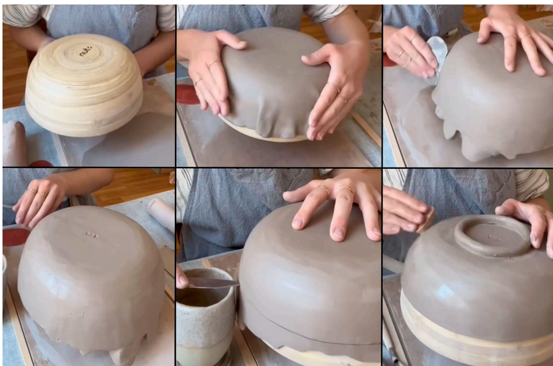
Figura 11: Demonstração do método Molde por sobreposição.
