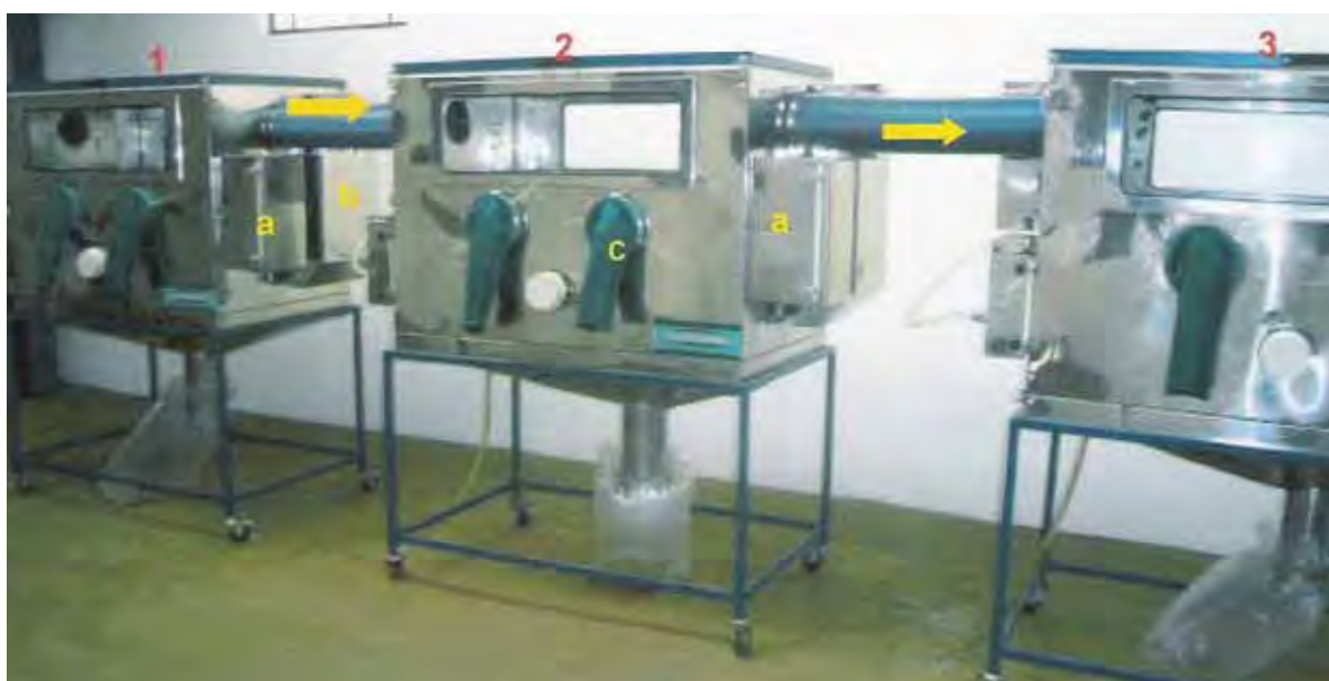
Figura 2: Posicionamento dos isoladores e das respectivas conexões para o estudo da transmissão aérea de Salmonella – (1) isolador para animais-controle; (2) animais infectados e (3) animais-sentinelas. As setas amarelas indicam o fluxo unidirecional do ar. (a) câmara de passagem; (b) reservatório de ração; (c) luvas para colheitas de amostras.
