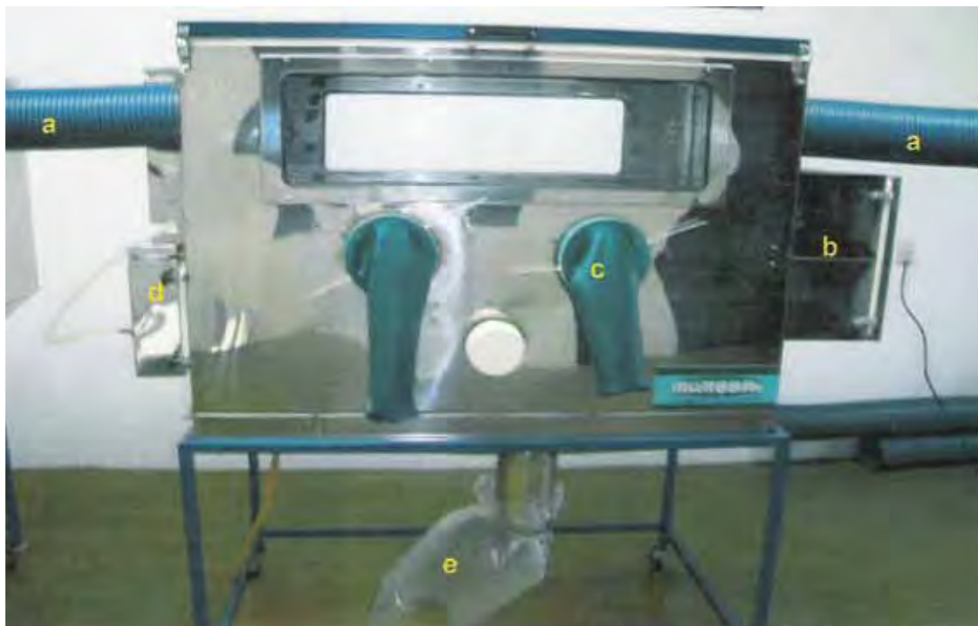
Figura 1: Baia isoladora para estudos epidemiológicos de transmissão de agentes infecciosos em suínos – (a) tubos de ar e conectores; (b) câmara de passagem, (c) luvas externas que permitiram acesso ao interior do isolador para contenção e colheita das amostras; (d) bebedouro e reservatório de água e (e) saco para depósito de dejetos.
