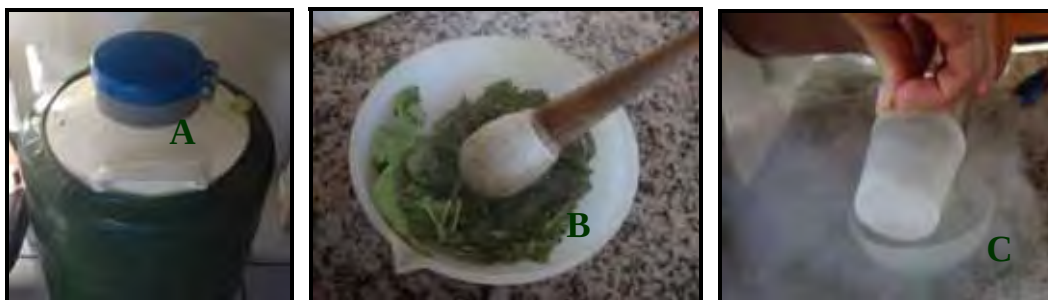
Figura 9. Avaliação da atividade de peroxidase e polifenoloxidase. (A) Botijão com nitrogênio líquido; (B e C) Maceramento de folhas com nitrogênio líquido.
