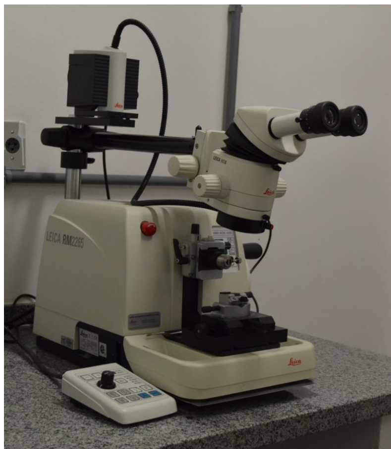
Figura 14 - Micrótomo Leica RM2265 utilizado para obtenção dos cortes histológicos dos nervos, acoplado com lupa de aumento Leica MZ6.
