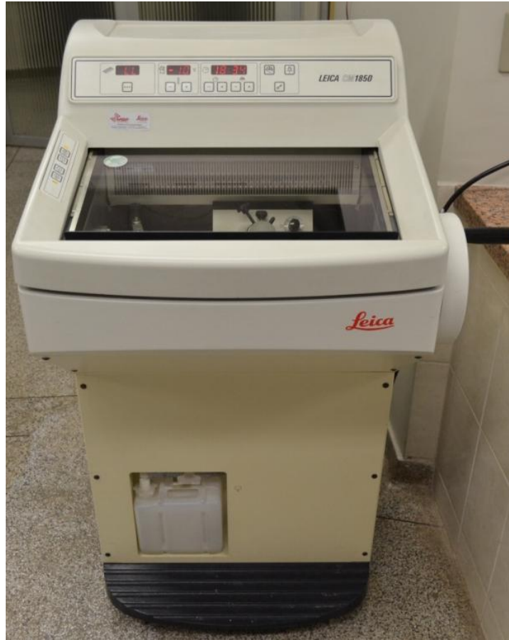
Figura 13- Aparelho de Criostato Leica CM1850 utilizado para obtenção dos cortes musculares.
