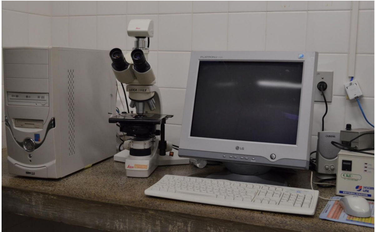
Figura 15- Sistema de análise de imagem - Micro computador com o software de captura e análise de imagem, acoplado ao microscópio Leica DMLS.
