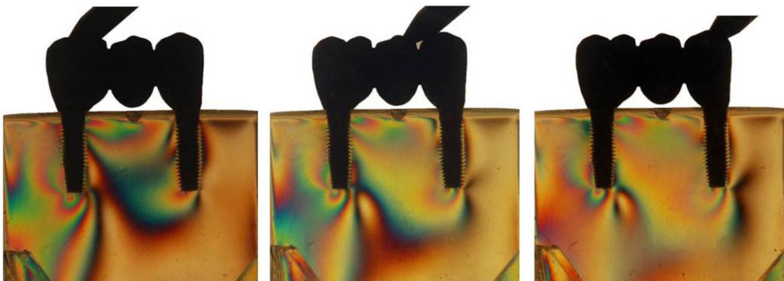
Figura 22: Distribuição das tensões no grupo I (carga oblíqua)
