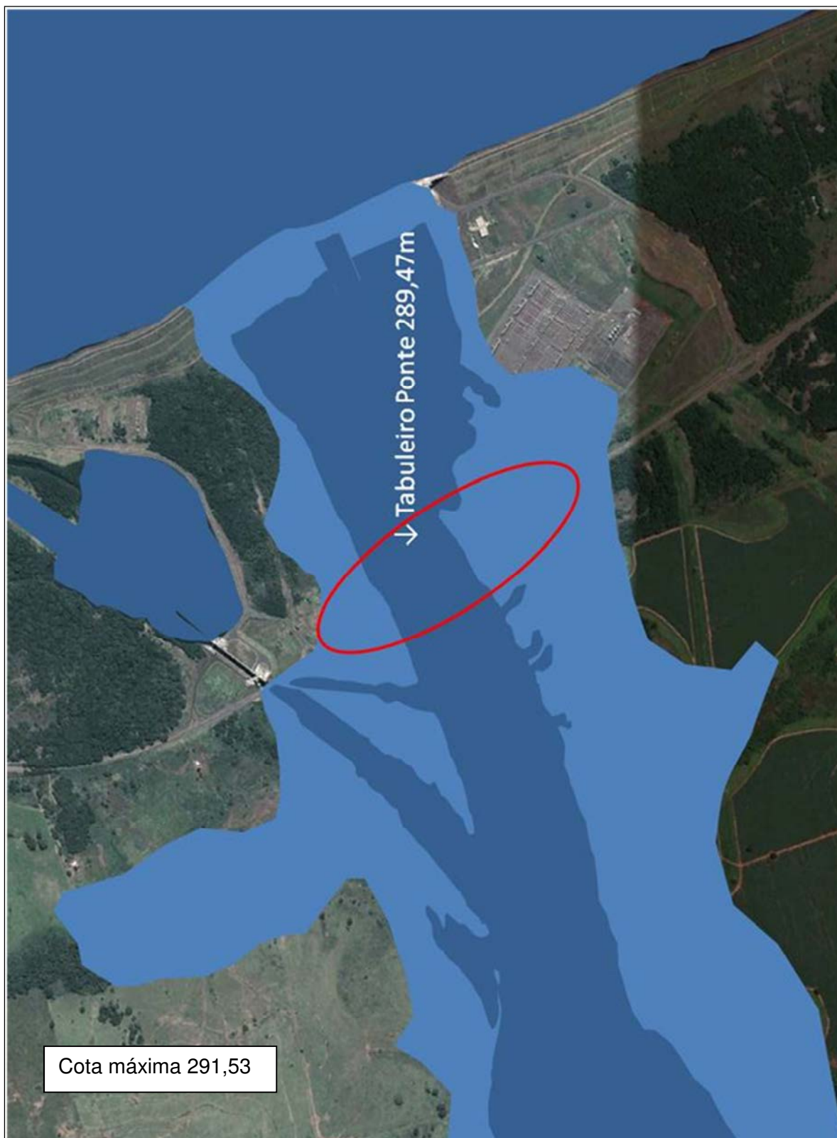
Figura 38 – Ponte Três Irmãos. Mapa de inundação para a ruptura hipotética com vazão de 40.500 \text{ m}^3/\text{s} .
