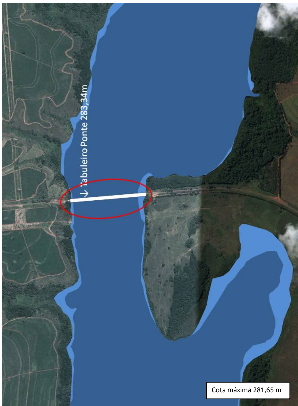
Figura 15 – Ponte Itapura. Mapa de inundação com defluência induzida de 11.000 m 3 /s.
