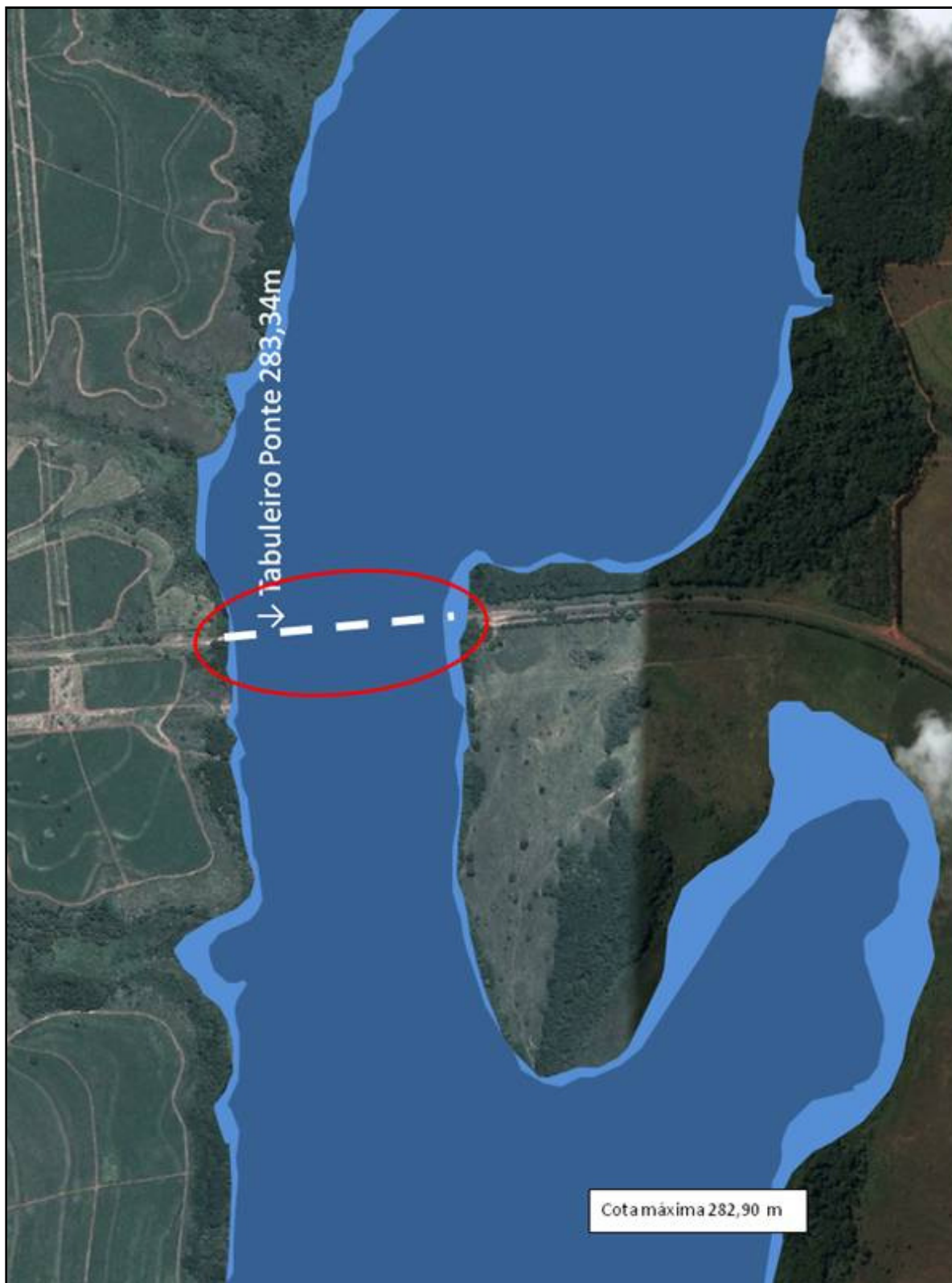
Figura 46 – Ponte Itapura. Mapa de inundação com defluência de 20.915 m 3 /s.
