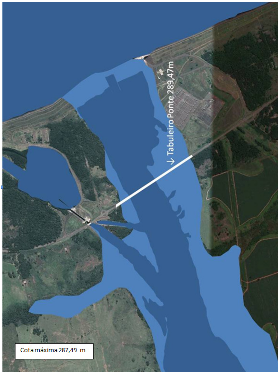
Figura 37 – Ponte Três Irmãos. Mapa de inundação para a ruptura hipotética com vazão de 20.915 \text{ m}^3/\text{s} .
