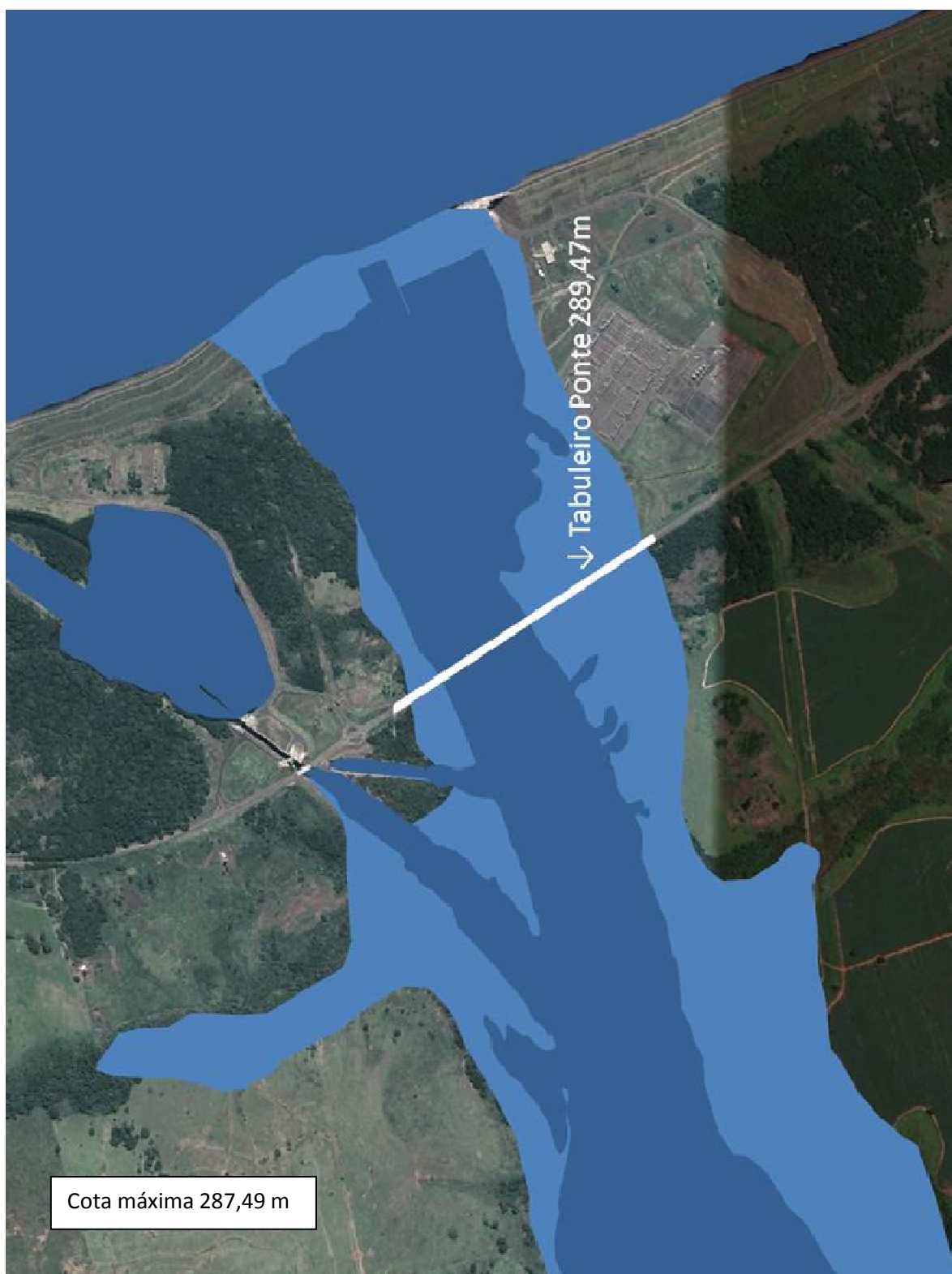
Figura 10 – Ponte Três Irmãos. Mapa de inundação para a ruptura hipotética com vazão de 20.915 \text{ m}^3/\text{s} .
