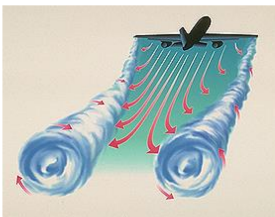
Figura 1 - Esboço da esteira formada a jusante de uma aeronave durante um procedimento de decolagem
