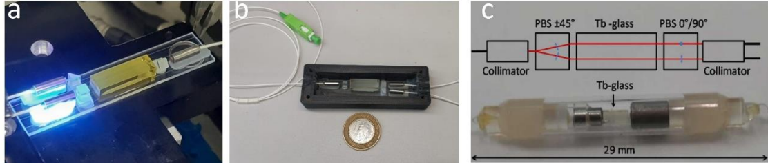
Figura 10. (a) Fotografia do protótipo a base do vidro BGB-16Tb-0.25Ce, (b) do protótipo BAG13Tb e (c) do protótipo GBANPb-4Tb (5mm) construído utilizando o vidro como material sensível.
