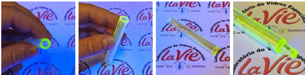
Figura 8. Tubo de vidro casca obtido pelo método “ lifting ” e fotografia da preforma NC pronta para puxamento na torre de fibra óptica.
