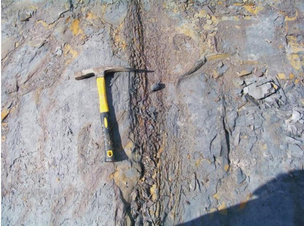
**Figura 7.23 - Perturbação no piso da cava, com material tectonizado no interior das fraturas, mostrando movimentação aparentemente sub-horizontal e pseudo-verticalização dos folhelhos.**
