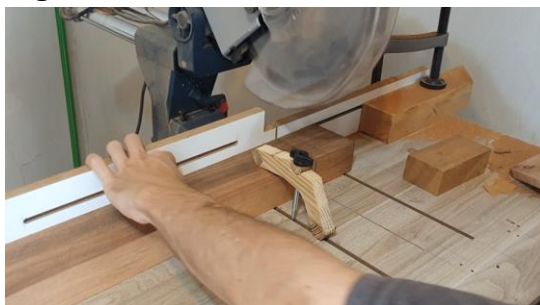
Fig. 51 – Cortando no tamanho final
