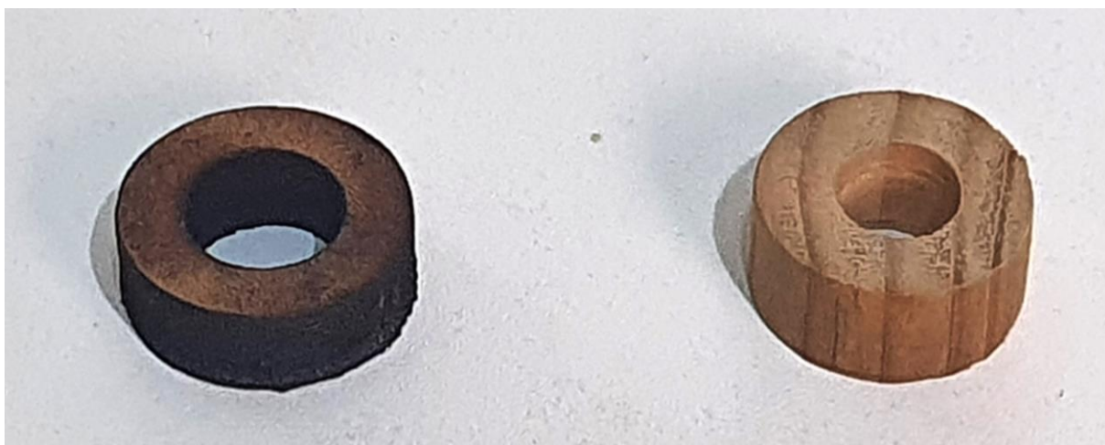
Fig. 78 – Comparação da peça de MDF cortada a laser e da peça de madeira maciça
