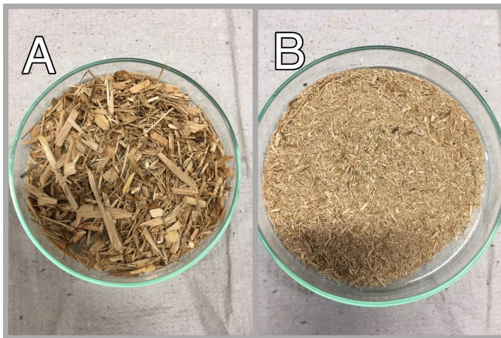
Figura 11. Subproduto oriundo do processamento da indústria de celulose. (a) Subproduto original (SO). (b) Subproduto original moído (SOM).
