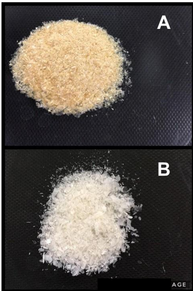
Figura 15. Hemiceluloses extraídas com \text{H}_2\text{O}_2 6% (massa/volume) por 12h. (a) Hemicelulose extraída do subproduto apenas moído-extraído (HSE). (b) Hemicelulose extraída do subproduto moído-extraído e pré-tratado com clorito de sódio por 180 min (HSEP).
