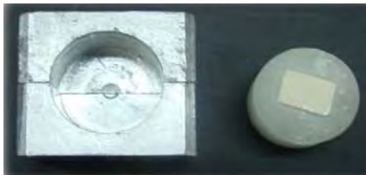
Figura 04 a) Matriz de alumínio para inclusão das amostras, contendo um compartimento circular; b) amostra incluídas em resina acrílica.
