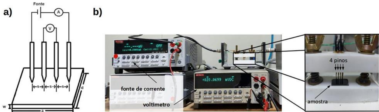
Figura 9 – a) Ilustração de amostras retangulares que possuem comprimento finito "a", largura limitada "d" e espessura "w", as quais são depositadas sobre substratos não-condutores. b) Fotografia do equipamento disponível.
