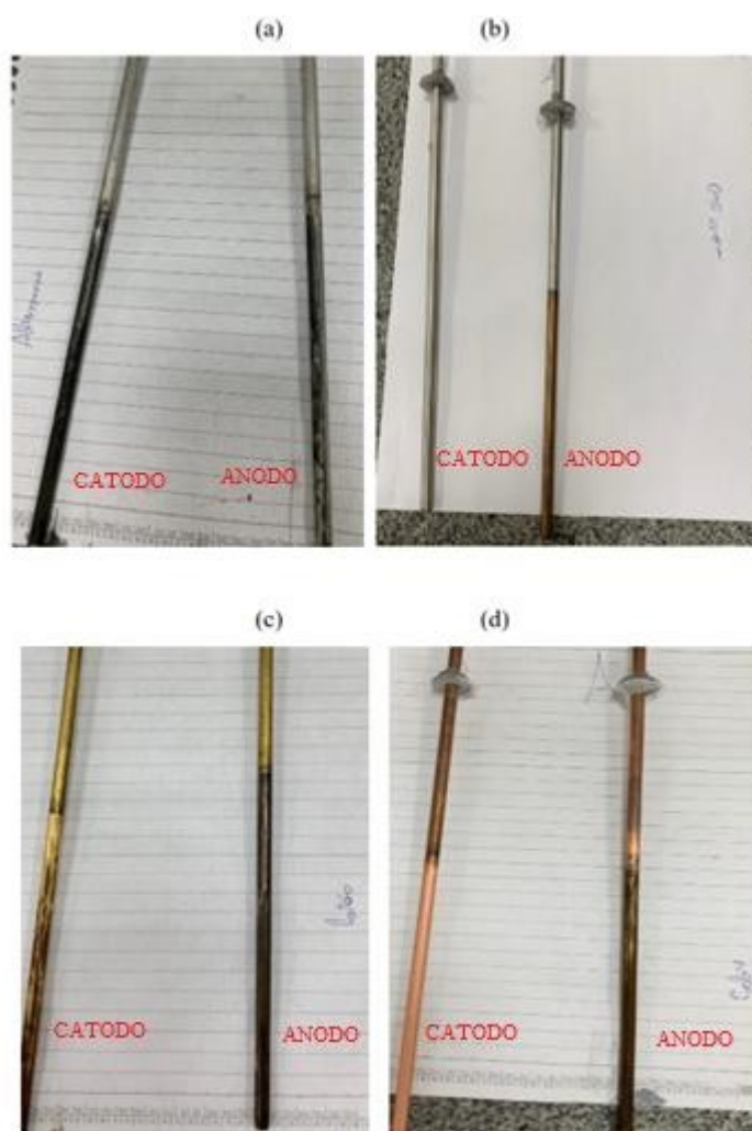
Figura 19 - Eletrodos após as reações químicas de oxirredução utilizando a solução de eletrólito KOH: (a) Alumínio, (b) Aço Inox, (c) Latão e (d) Cobre
