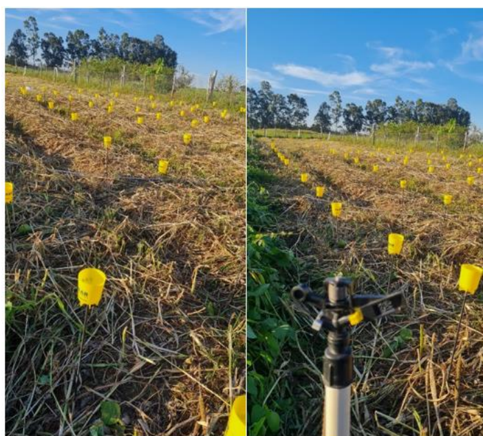
Figura 18. Teste de Coeficiente de Uniformidade de Christiansen (CUC), UNESP, Dracena-SP, 2023.
