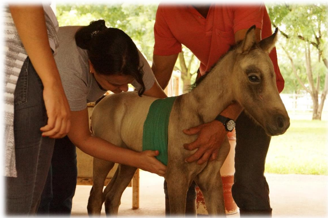
Figura 1 – Colocação e fixação do equipamento de análise de andamento Equimetrix ® (Centaure Métrix, Fontainebleau, France) com atadura elástica autoadesiva em potro. Crédito: Juliana R. Peiró.
