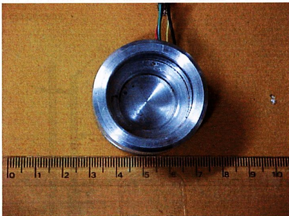
Figura 3.8 – Vista da estrutura interna da câmara com extensômetro.
