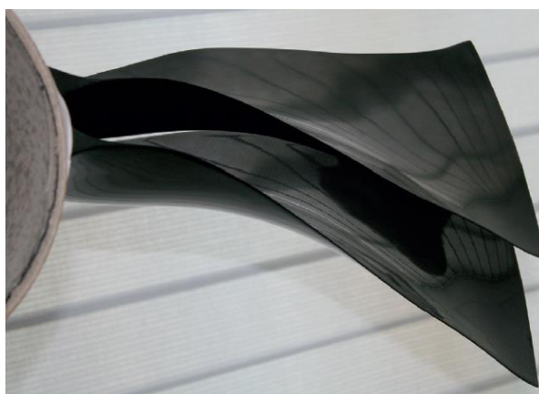
Figura 7 - Hélice de turbina fabricada em carbono/epóxi
