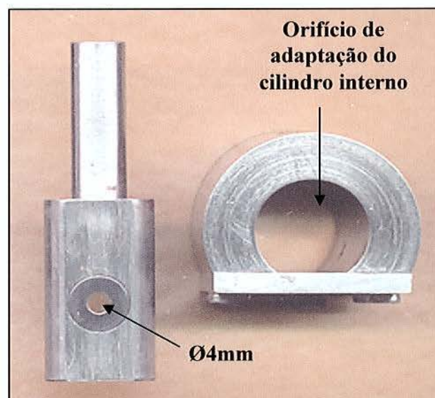
FIGURA 20 - Dispositivo metálico para a realização do ensaio de cisalhamento (Itinoche 29 , 1999)
