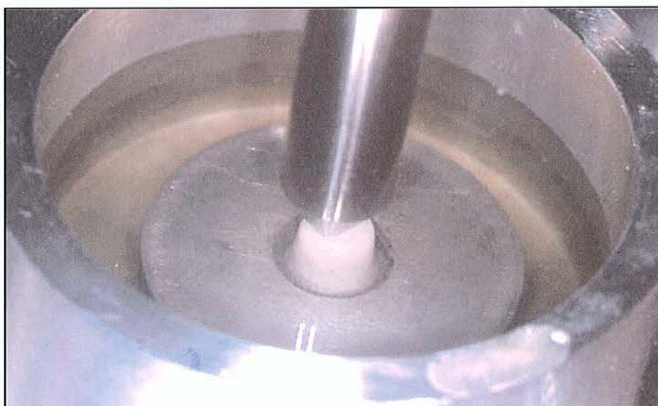
FIGURA 19 - Ensaio de ciclagem mecânica, mostrando o sentido do impacto repetitivo na superfície do corpo-de-prova*
