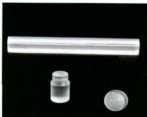
FIGURA 1 - Matrizes em resina acrílica calcinável utilizadas para confecção dos corpos-de-prova
