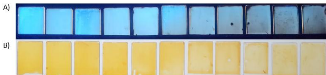
Figura 52- Amostras para as velocidade de 31.75 cm/min a 0,51 cm/min, (A) amostras sendo excitadas por uma lâmpada ultravioleta, (B) amostras em luz ambiente.
