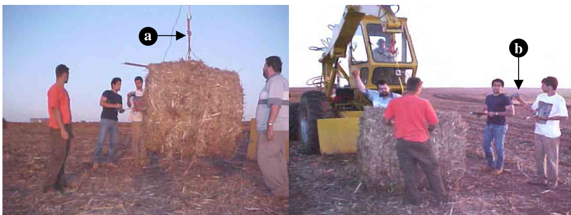
Figura 18 – Pesagem individual de cada fardo. Detalhe da célula de carga (a) montadas em uma carregadora de cana adaptada em guincho e "display" digital (b).
