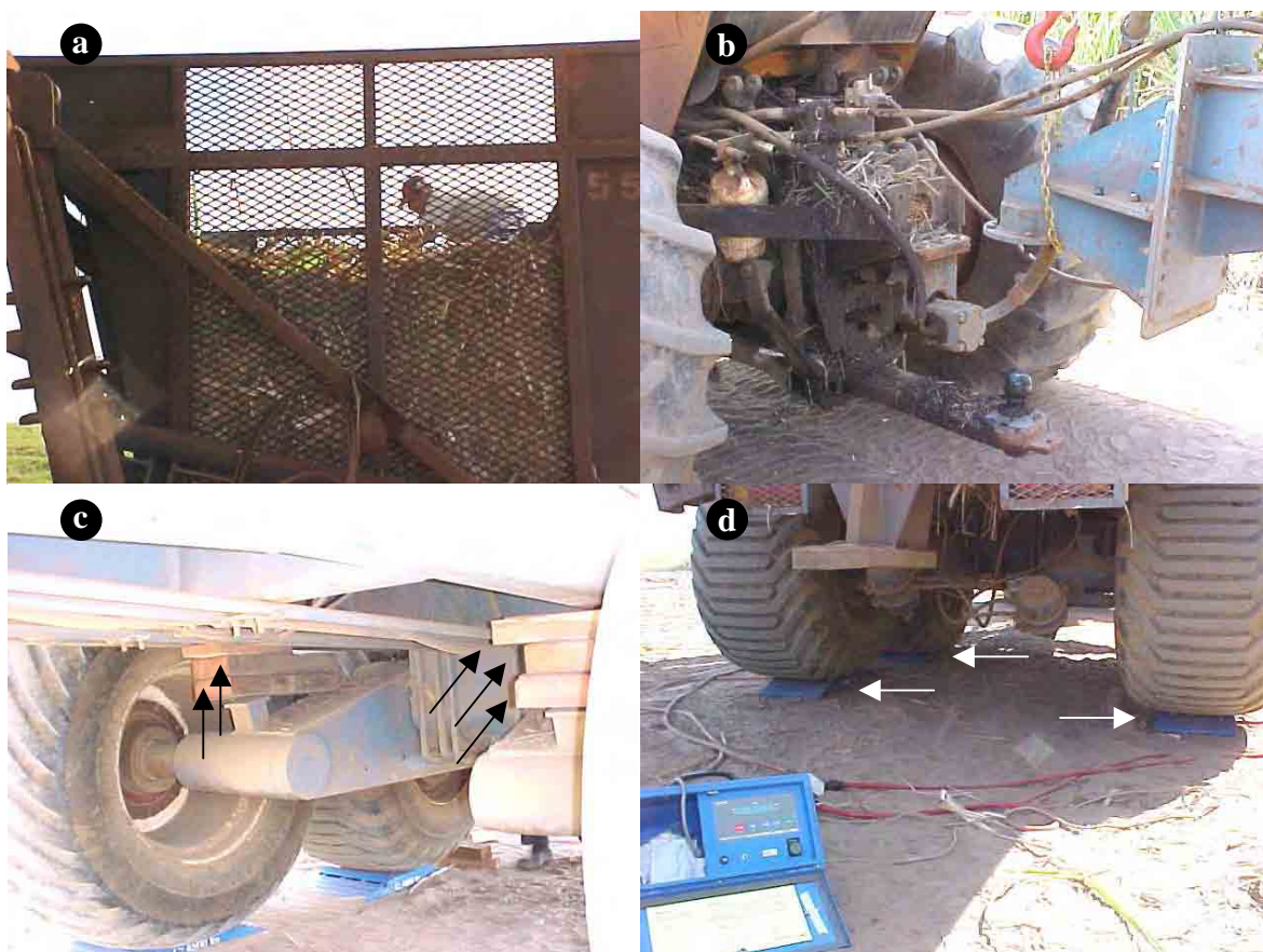
Figura 6 – Nivelamento da carga antes da pesagem do transbordo (a); desacoplamento do transbordo da barra de tração do trator, por guincho hidráulico (b); pedaços de madeira para manter estável a unidade desacoplada (c) e balanças, uma sob cada roda, com “display” de leitura (d).
