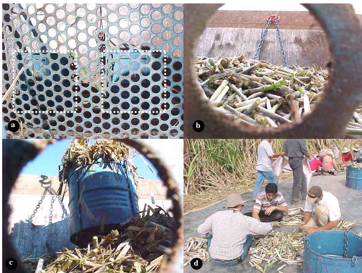
Figura 7 – Tambores posicionados dentro da unidade de transbordo no início de cada repetição (a); tambores cobertos pela matéria-prima colhida (b); retirada dos tambores, após a realização de repetição (c) e início da separação das frações contidas no tambor de amostragem sobre o encerado (d).
