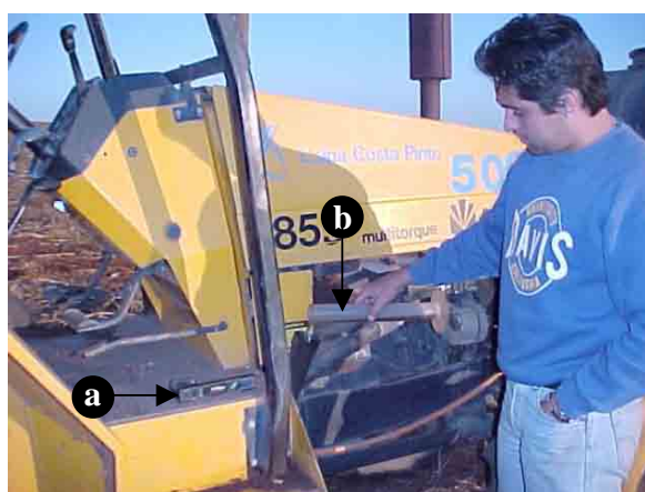
Figura 19 – Determinação do consumo de combustível, por tratamento (nível de bolha (a) e bureta graduada (b)).
