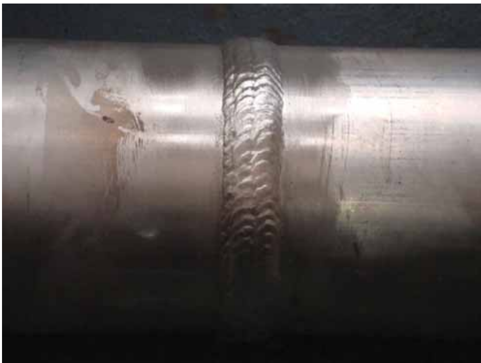
Figura 22 - Detalhe do cordão de solda do corpo-de-prova "D"
