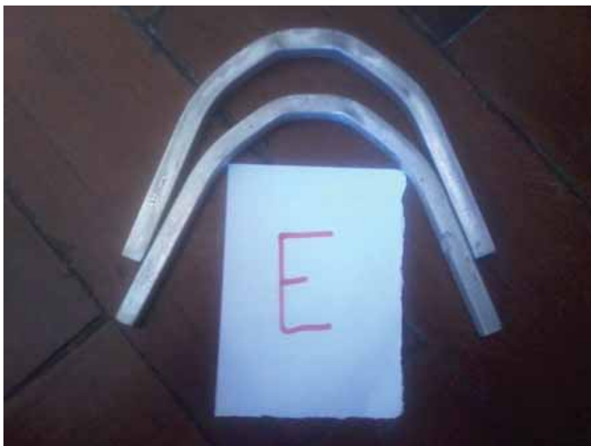
Figura 24 – Ensaio de dobra no corpo-de-prova “E”
