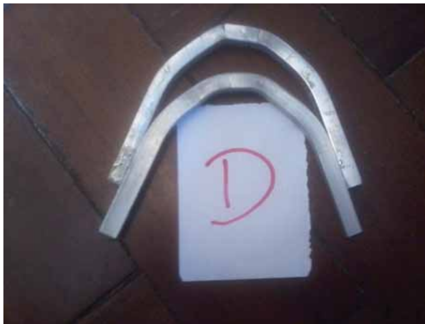
Figura 36 – Ensaio de dobra no corpo-de-prova “D”
