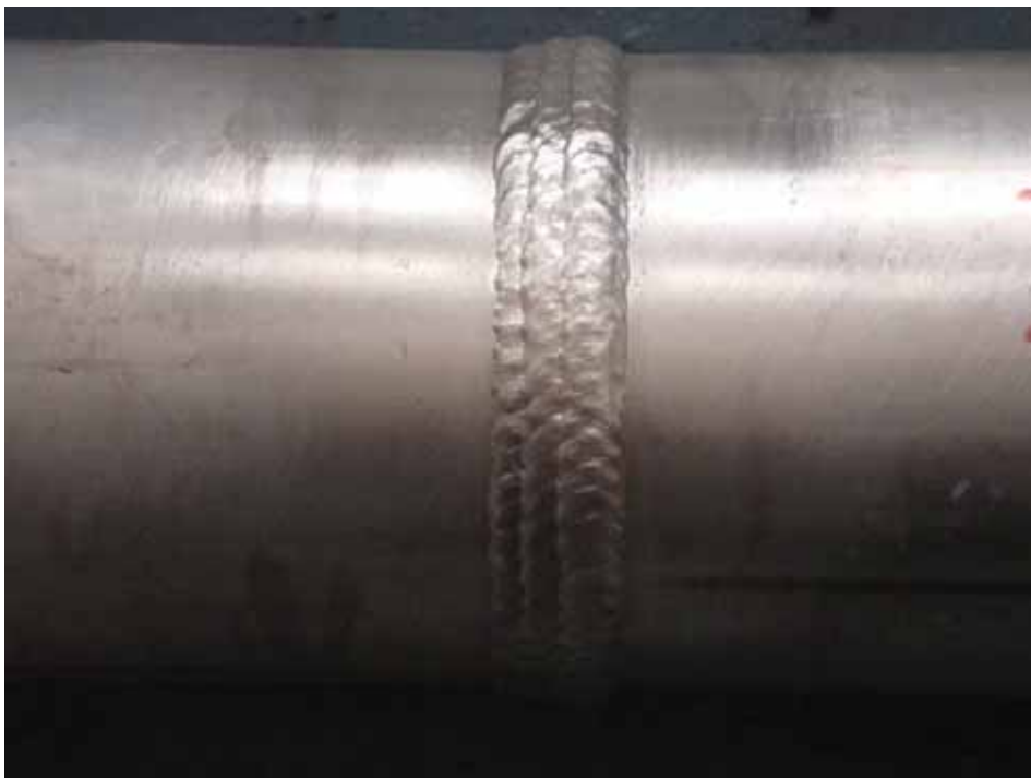
Figura 16 - Detalhe do cordão de solda do corpo-de-prova “B”
