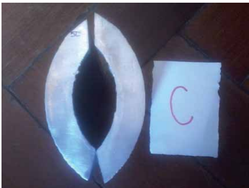
Figura 32 – Análise visual dos poros no corpo-de-prova “C”
