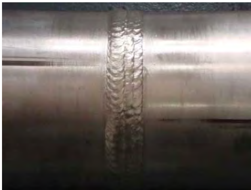
Figura 20 - Detalhe do cordão de solda do corpo-de-prova “A”
