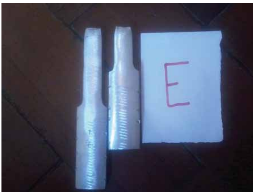
Figura 25 – Ensaio de tração no corpo-de-prova “E”
