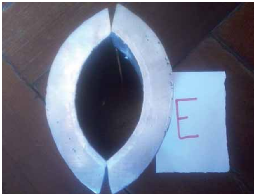
Figura 26 – Análise visual dos poros no corpo-de-prova “E”
