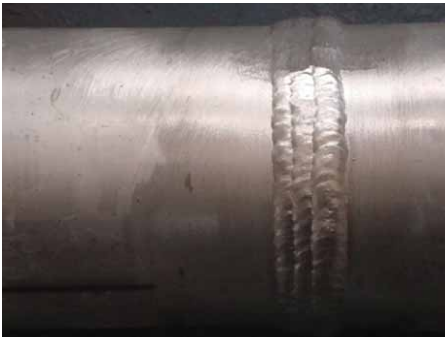
Figura 14 - Detalhe do cordão de solda do corpo-de-prova “E”
