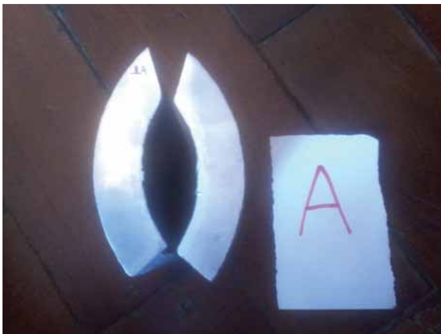
Figura 35 – Análise visual dos poros no corpo-de-prova “A”
