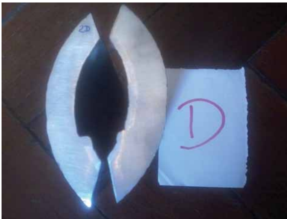
Figura 38 – Análise visual dos poros no corpo-de-prova “D”
