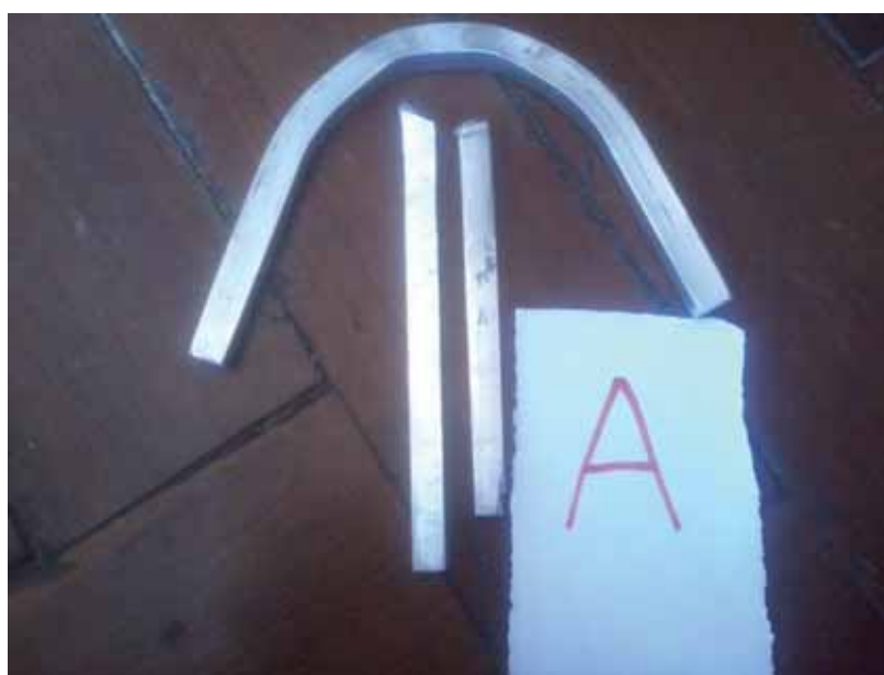
Figura 33 – Ensaio de dobra no corpo-de-prova “A”
