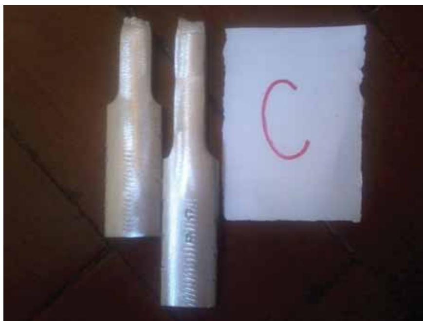
Figura 31 – Ensaio de tração no corpo-de-prova “C”
