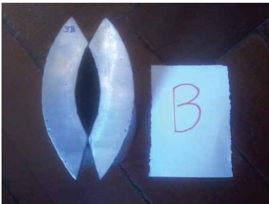
Figura 29 – Análise visual dos poros no corpo-de-prova “B”
