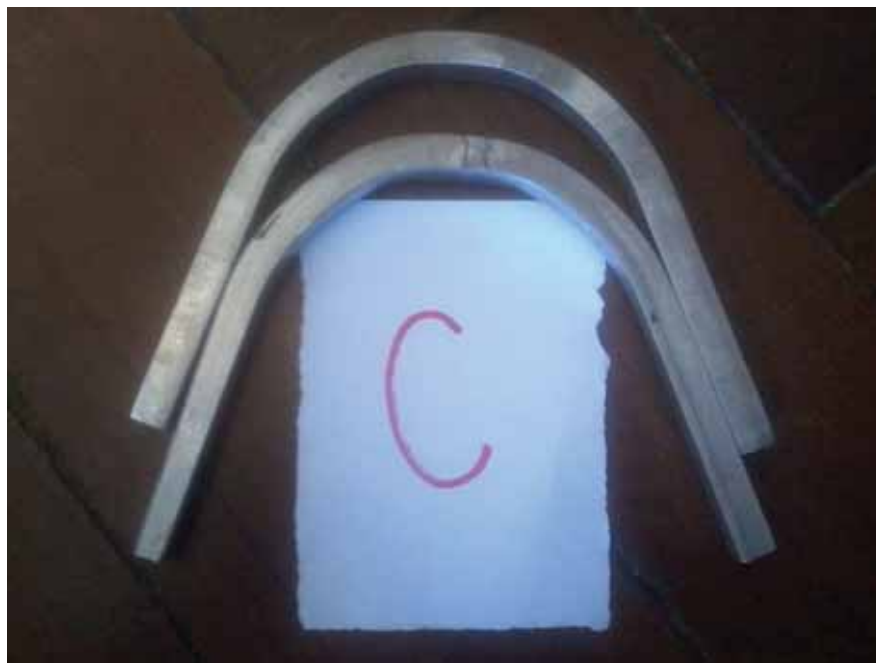
Figura 30 – Ensaio de dobra no corpo-de-prova “C”
