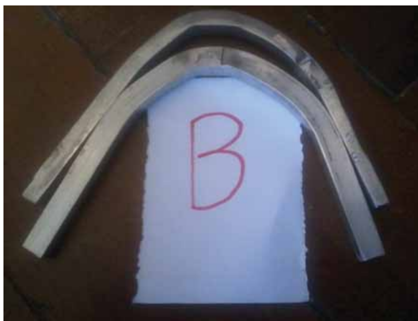
Figura 27 – Ensaio de dobra no corpo-de-prova “B”
