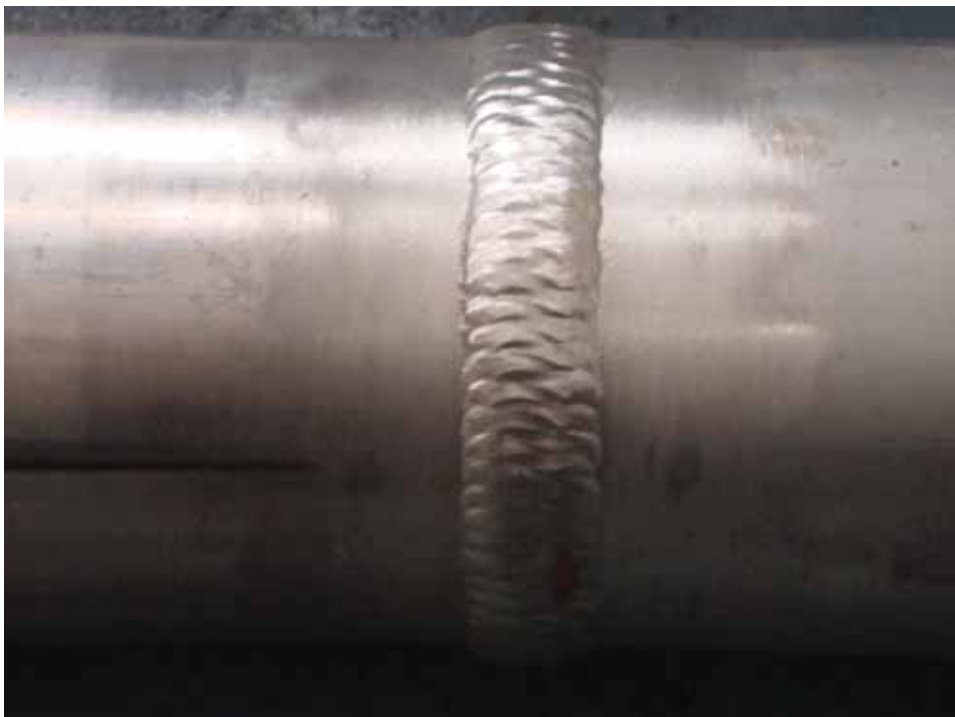
Figura 18 - Detalhe do cordão de solda do corpo-de-prova “C”
