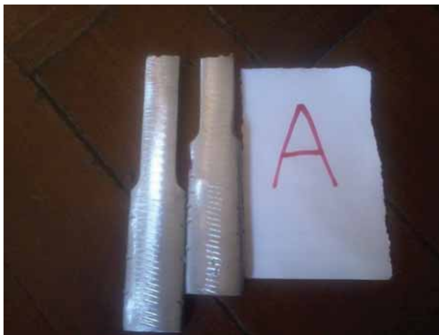
Figura 34 – Ensaio de tração no corpo-de-prova “A”
