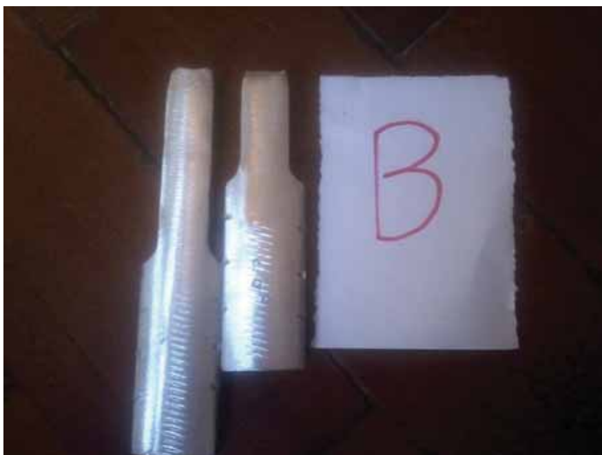
Figura 28 – Ensaio de tração no corpo-de-prova “B”
