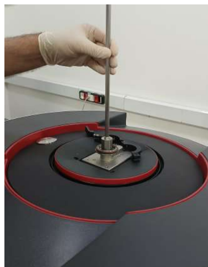
Figura 69 – Introdução do porta-amstras no equipamento
