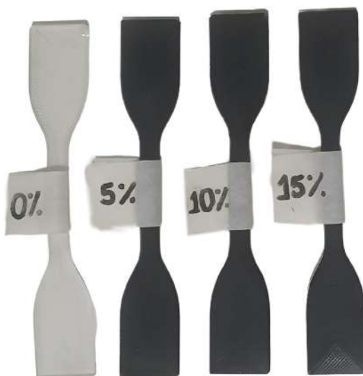
Figura 80 – Corpos de prova de compósitos de PDMS com diferentes percentuais de nanopartículas, seguindo o Tipo 4 da norma ASTM D638-14
