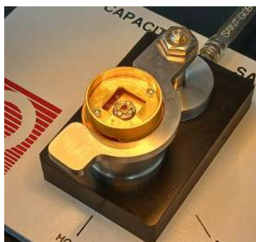
Figura 68 – Deposição da graxa do tipo H no porta-amstras
