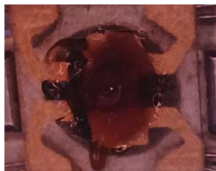
Figura 68 – Deposição da graxa do tipo H no porta-amstras
