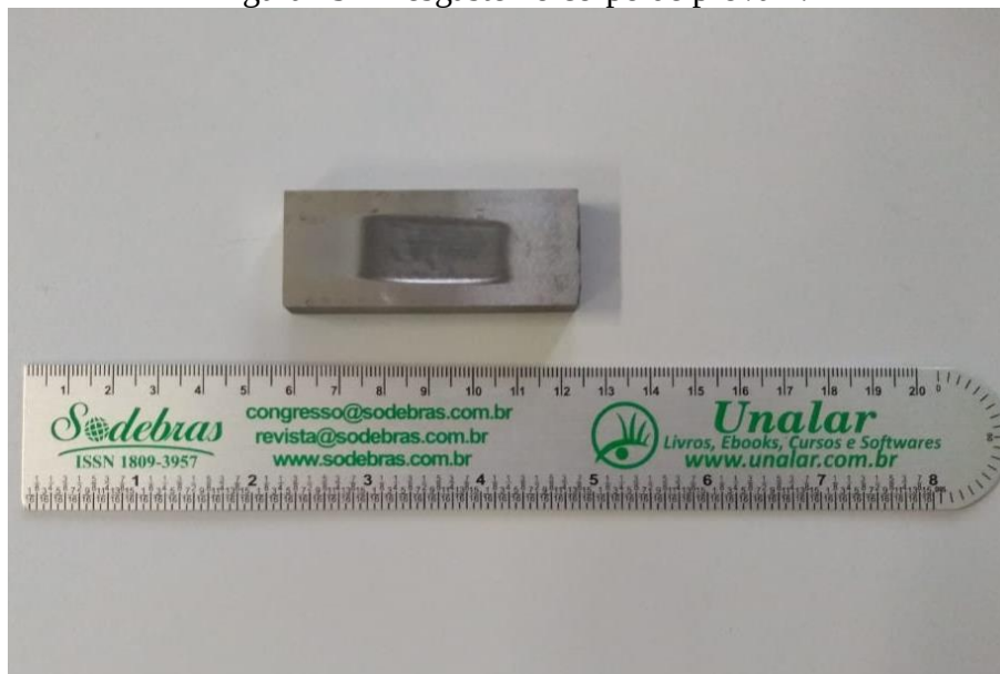
Figura 29 - Desgaste no corpo de prova 2.
