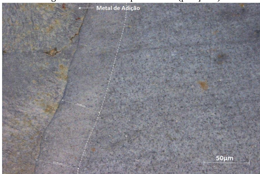
Figura 27 - ZTA 200x por LASER (posição 1).
