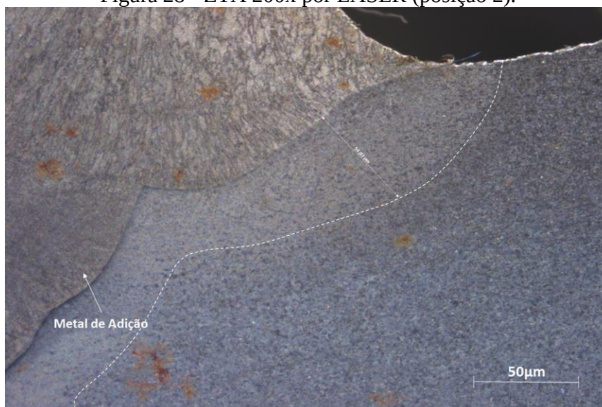
Figura 28 - ZTA 200x por LASER (posição 2).
