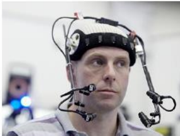
Figura 2 – Sistema de câmeras utilizado para capturar as expressões faciais do ator
