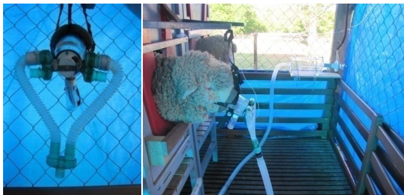
Figura 3. Máscara facial respiratória desenvolvida para ovinos no Laboratório de Bioclimatologia da UNESP, Câmpus de Jaboticabal.
