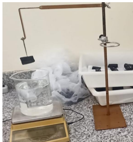
Figura 6. Determinação da densidade básica do carvão pelo método de imersão em água. (Foto: o autor)
