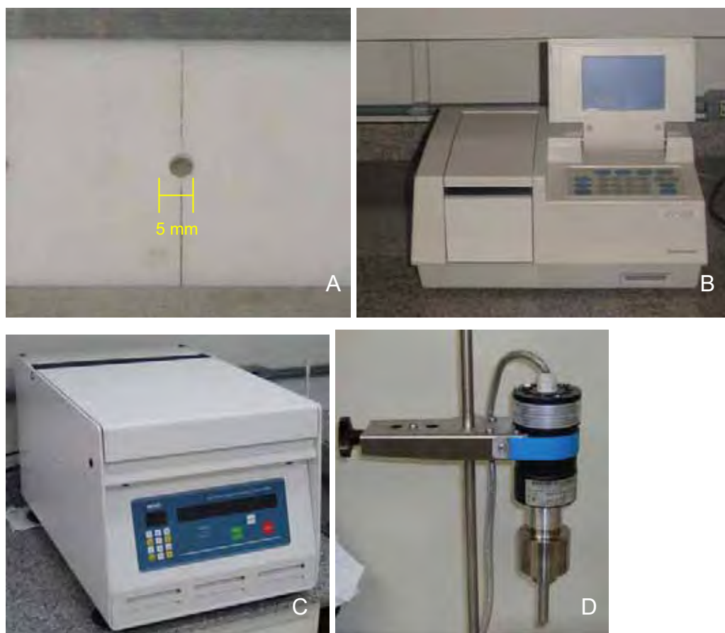
FIGURA 5 – (A) Matriz de teflon bi-partida; (B) Espectrofotômetro; (C) Centrífuga refrigerada; (D) Homogeneizador ultra-sônico.
