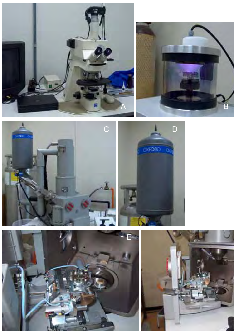
FIGURA 3 – (A) Fotomicroscópio de luz com acessório para polarização; (B) Plasma de ouro sendo depositado sobre espécimes em metalizador; (C) Microscópio eletrônico de varredura; (D) Acessório para espectroscopia para dispersão de raios-X; (E e F) Stub com espécimes sendo colocado dentro do microscópio eletrônico de varredura
