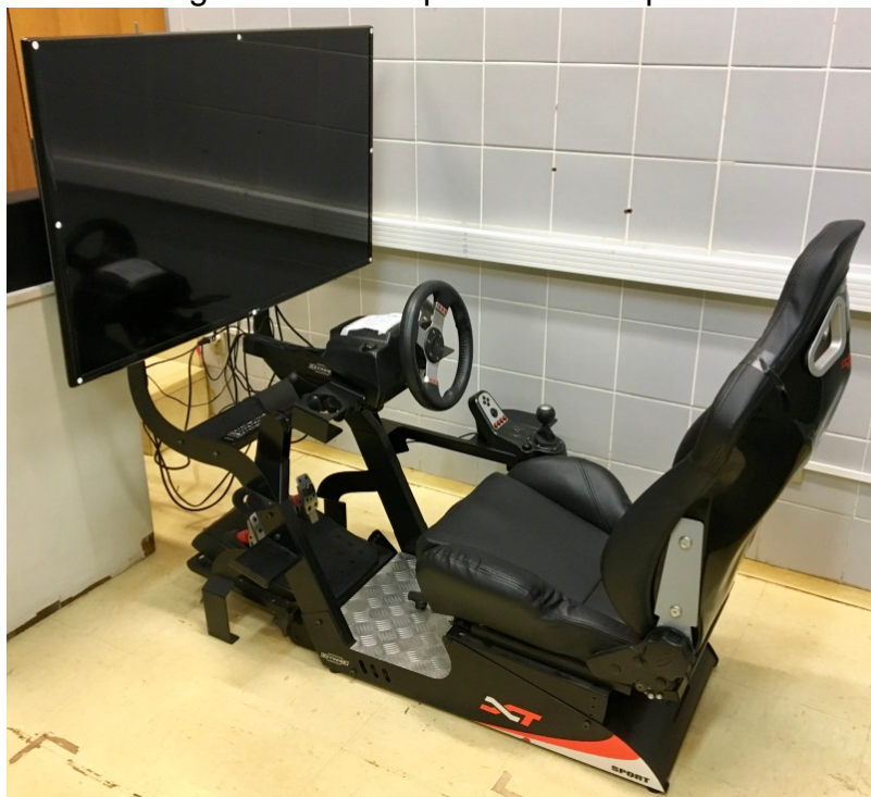
Figura 42 - Estrutura montada do Cockpit com banco de couro reclinável e ajustável, o suporte para a televisão Samsung 46" e kit de acessório Gamer Logitech G27 acoplado ao Cockpit.
