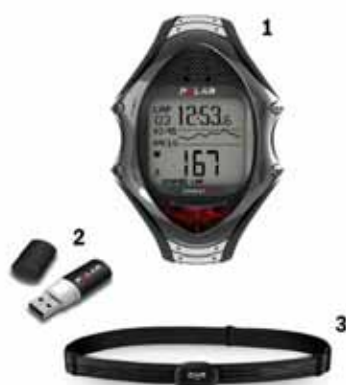
Figura 3. Número 1 ilustra o relógio cardiofrequencímetro da marca Polar modelo RS800CX, número 2 demonstra o receptor que foi inserido no computador para a transmissão dos arquivos, e a número 3 ilustra a cinta elástica com transmissor.
