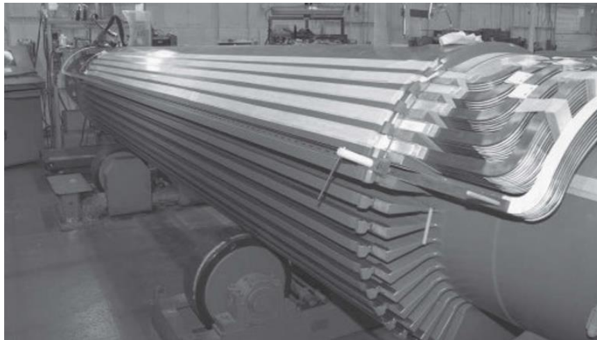
Figura 36 – Rotor de polos não-salientes
