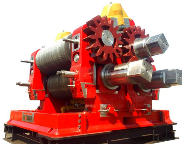
Figura 10 – Terno de moenda de cana-de-açúcar
