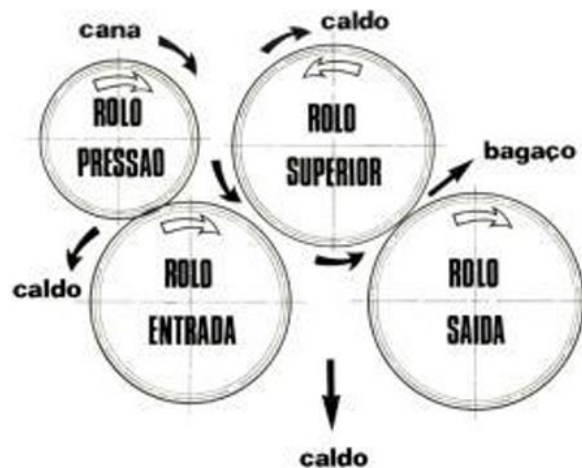
Figura 11 – Corte lateral dos rolos metálicos de uma moenda de cana-de-açúcar
