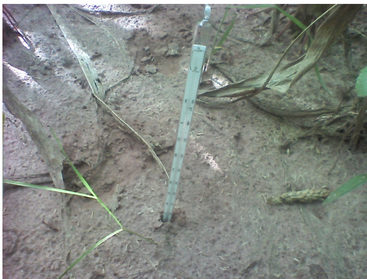
Figura 1B. Fotografia mostrando a colocação do termômetro de mercúrio utilizado para as medições de temperatura do solo.
