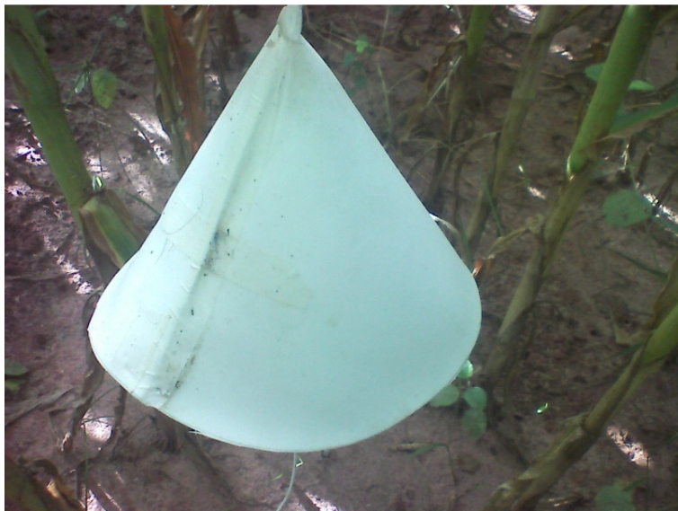
Figura 1A. Fotografia do cone de EVA utilizado no experimento para proteção dos termohigrômetros digitais.
