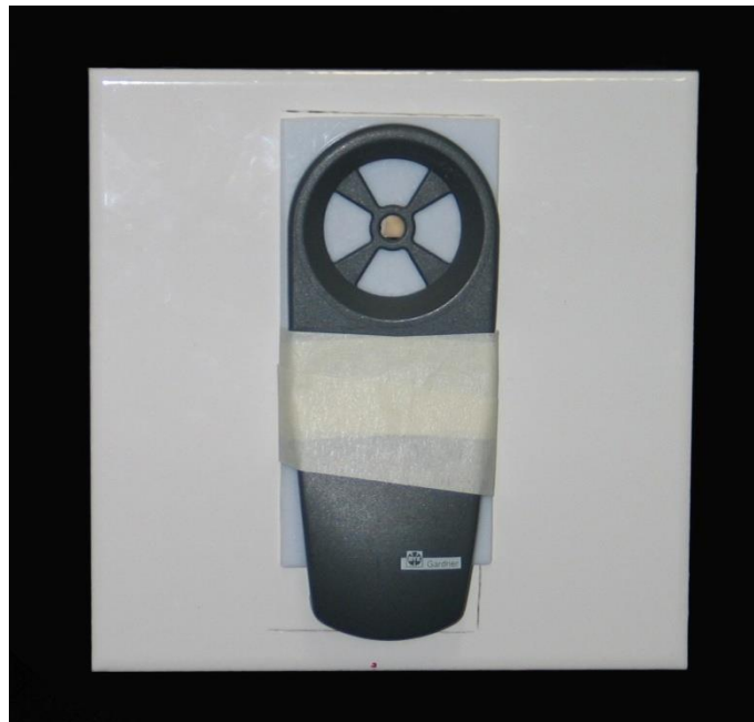
Figura 10. Conjunto anteparo/posicionador do espectrofotômetro disposto sobre um azulejo branco com o corpo de prova posicionado no orifício central. Araraquara, São Paulo, 2014.
