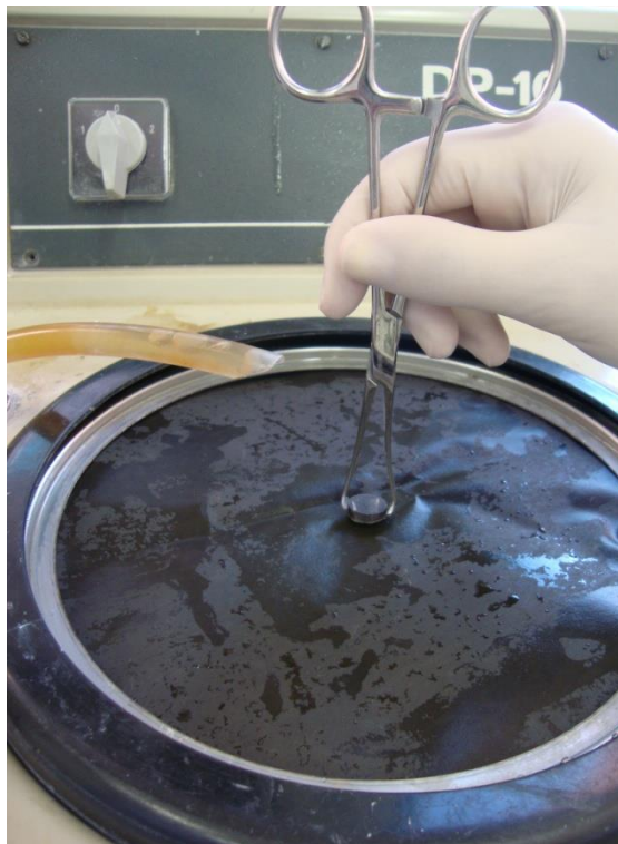
Figura 5. Aplainamento e polimento do corpo de prova com lixas d'água de granulação crescente sequencial (400, 600, 1200) na velocidade de 600rpm em uma politriz (PanambraStruers DP-10- Panambra, São Paulo, Brasil). Araraquara, São Paulo, 2014.
