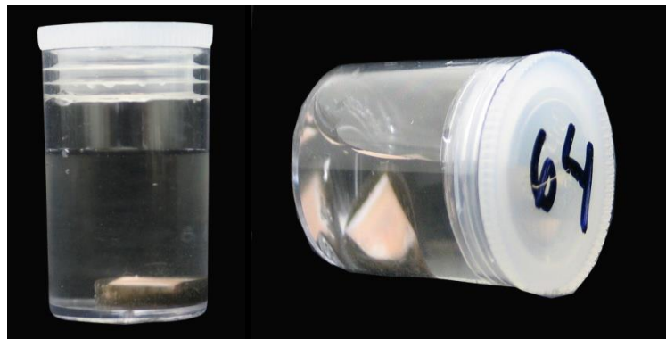
Figura 7. Armazenamento dos corpos de prova em saliva artificial no interior de recipientes plásticos com tampa identificados com números. Araraquara, São Paulo, 2014.
