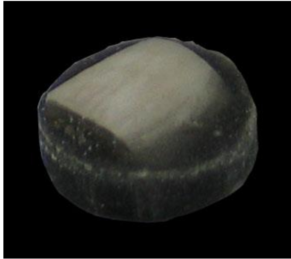
Figura 6. Corpo de prova com 10mm de diâmetro por 3mm contendo em sua parte central o espécime de dente bovino. Araraquara, São Paulo, 2014.
