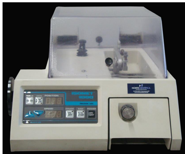
Figura 2. Máquina de corte Isomet 4000® - BUEHLER® utilizada para secção da raiz e corte do espécime. Araraquara, São Paulo, 2014.
