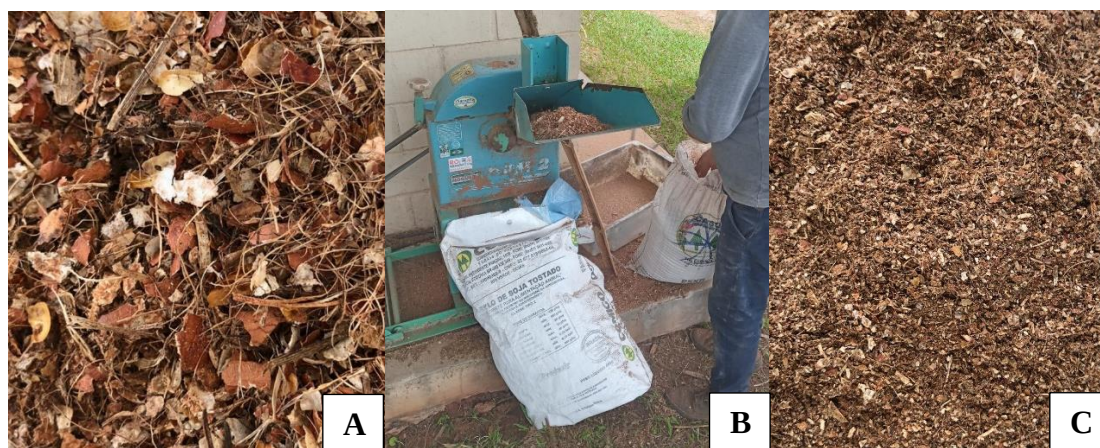
Figura 2: Preparo do resíduo do beneficiamento do amendoim. a) Resíduo inicial inteiro; b) Resíduo passando pelo processo de trituração; c) Resíduo final triturado.
