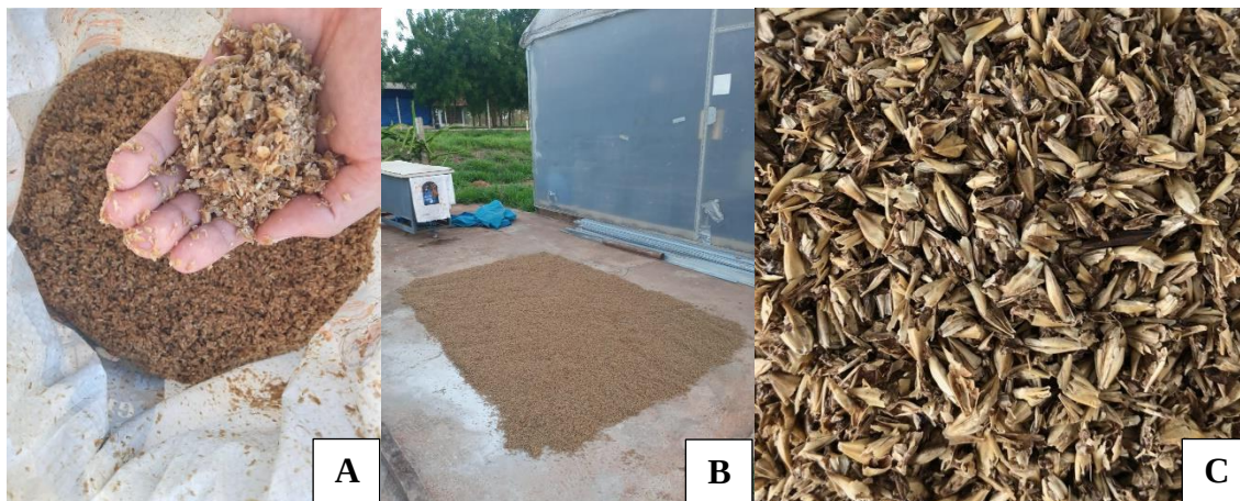
Figura 1: Preparo do bagaço de malte de cevada. a) Resíduo inicial úmido; b) Resíduo disposto para secagem; c) Resíduo final seco.
